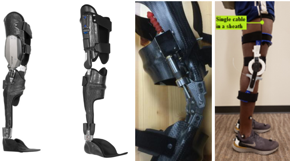
FIGURE 2.5 – Photos de différentes SCKAFO avec de gauche à droite : le C-Brace [Auberger et al., 2020], le E-Mag [Kim et al., 2016], l'OWVS [Lemaire et al., 2013] et le système de [Mioskowska et al., 2020]
