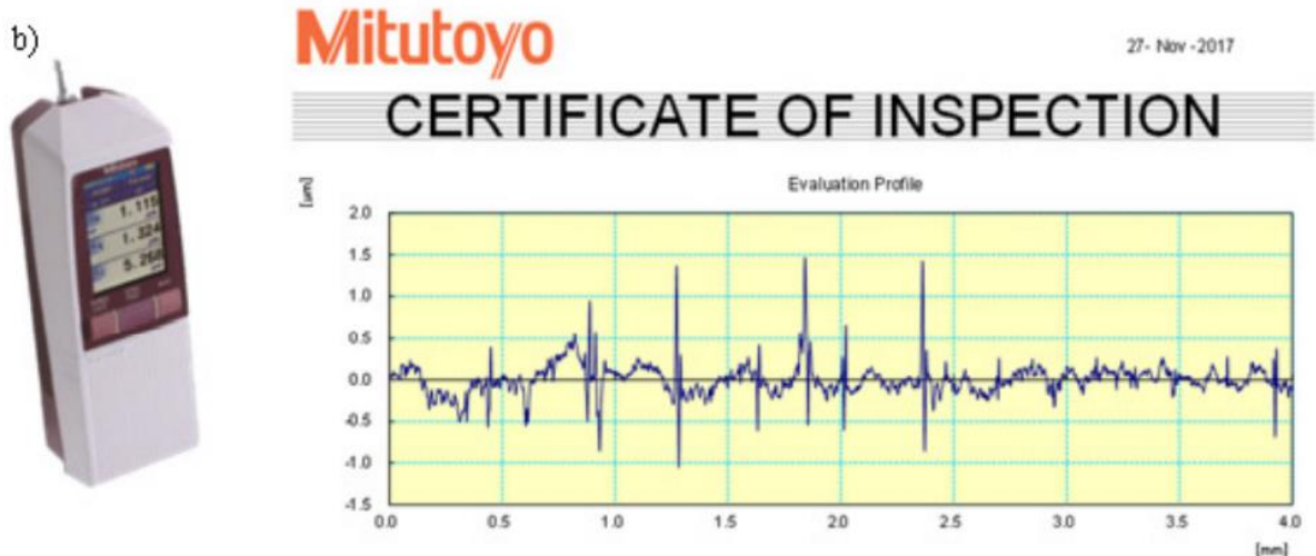
Figure II.7 Dispositifs pour la métrologie des surfaces : a) rugosimètre interférométrique confocal ; b) rugosimètre avec contact.
