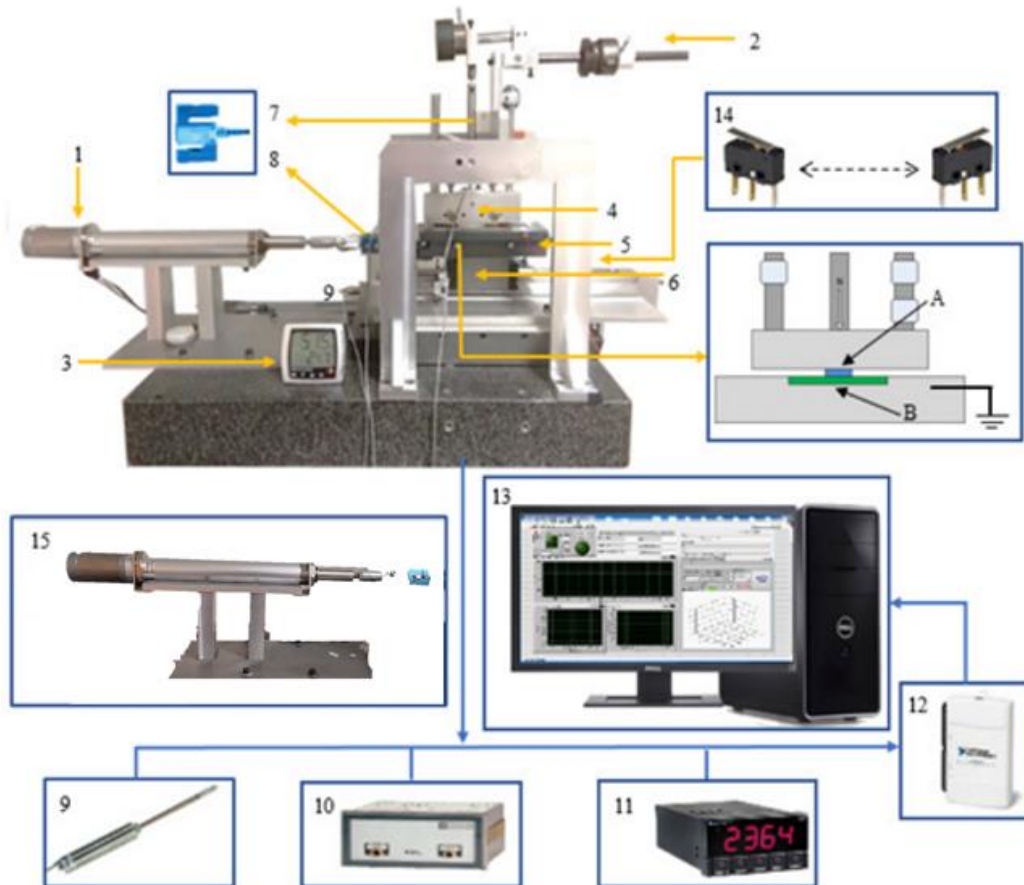
Figure II.10 Banc d'essai tribomètre plan/plan : A- L'échantillon supérieur reste fixe ; B-L 'échantillon inférieur est soumis à une translation alternative ; 1- Moteur linéaire ; 2- Système de contrôle de la force normale ; 3- Thermomètre et hygromètre ; 4- Support de l'échantillon supérieur ; 5- Support de l'échantillon inférieur ; 6- Guidage supporté par un roulement linéaire ; 7- Capteur de force normale ; 8- Capteur de force tangentielle ; 9- Capteur de déplacement linéaire ; 10- Conditionneur de capteur de déplacement ; 11 - Conditionneur de capteur de force ; 12- Carte d'acquisition de données ; 13- Interface d'acquisition LabView ; 14- Interrupteur de fin de course ; 15- Moteur rotatif. [64].
