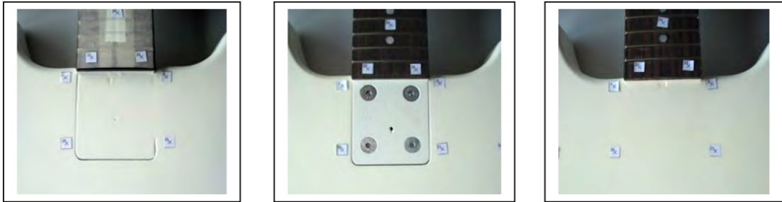
FIGURE 2.2 – Vues de dessus (guitare photographiée de face) des trois jonctions manche/corps caractéristiques de chacun des trois types de guitares fabriqués. Ces photos sont directement issues de la thèse de Benoît Navarret [Nav13]. De gauche à droite : manche collé (cas classique pour la Gibson Les Paul Junior ), manche vissé et manche traversant.
