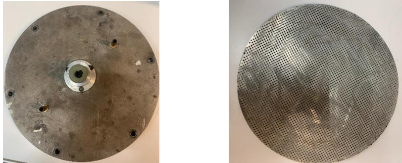
Figure 4.2 Couvercle et grille de la colonne de suffusion
