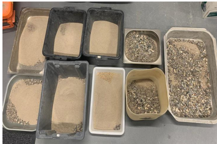
Figure 4.11 Matériaux constituant les configurations hétérogènes
