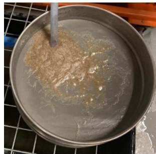
Figure 4.5 Récupération des particules érodées
