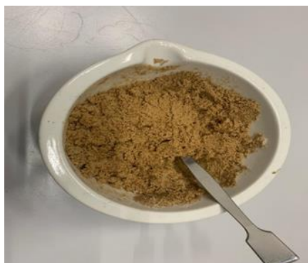
Figure 3.4 Mélange sable d'Hostun avec Limon
