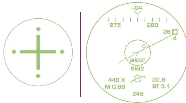
Figure 6 : Comparaison de la symbologie dans les viseurs et visuels de casque
