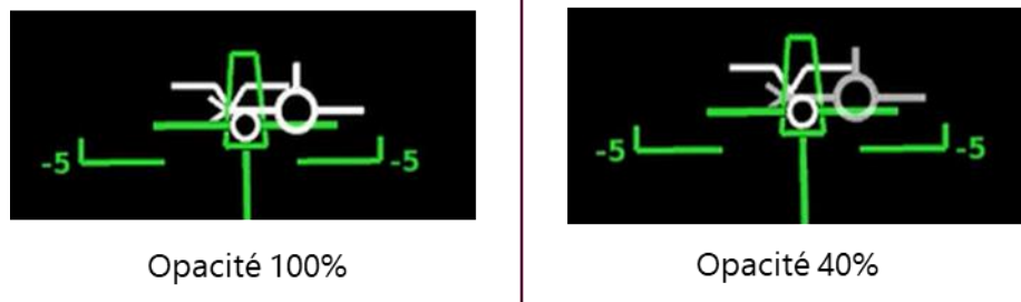
Figure 78 : Opacité maximale (100 %) et minimale (40 %) du FPV quand il est soumis à pulsation
