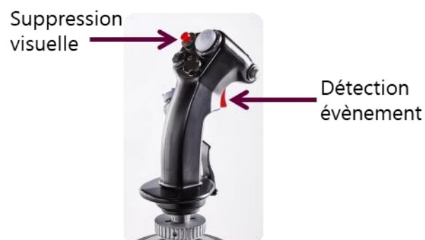
Figure 83 : Boutons du joystick utilisés pour la tâche de détection d'évènement et le signalement d'une suppression visuelle
