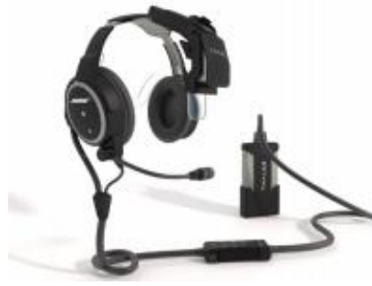
Figure 72 : Casque de réalité augmentée semi-transparent monoculaire, le TopMax®
