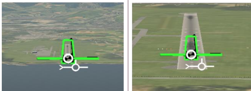
Figure 88 : Piste réelle et piste synthétique en début (gauche) et en fin d'essai (droite)
