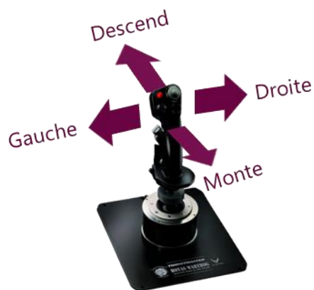
Figure 81 : Fonctionnement du joystick pour la tâche de suivi de cible
