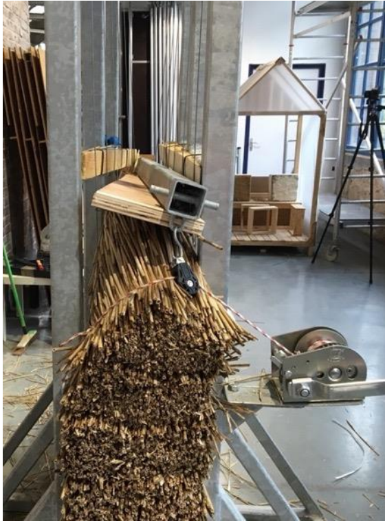
Figure 205 : Première compression du préprototype, 27/11/20, crédit Carole Lemans
