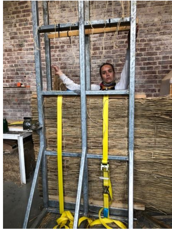
Figure 235 : Arrêt en mi-compression pour réparer les câbles, 29/04/21, crédit Carole Lemans
