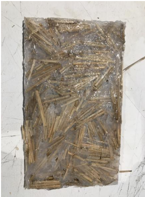
Figure 147 : Tiges de petite section et silicone, séance du 07/11/19, crédit Carole Lemans
