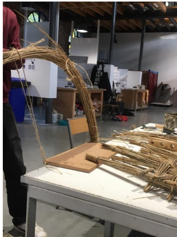
Figure 147 : Tiges de petite section et silicone, séance du 07/11/19, crédit Carole Lemans
