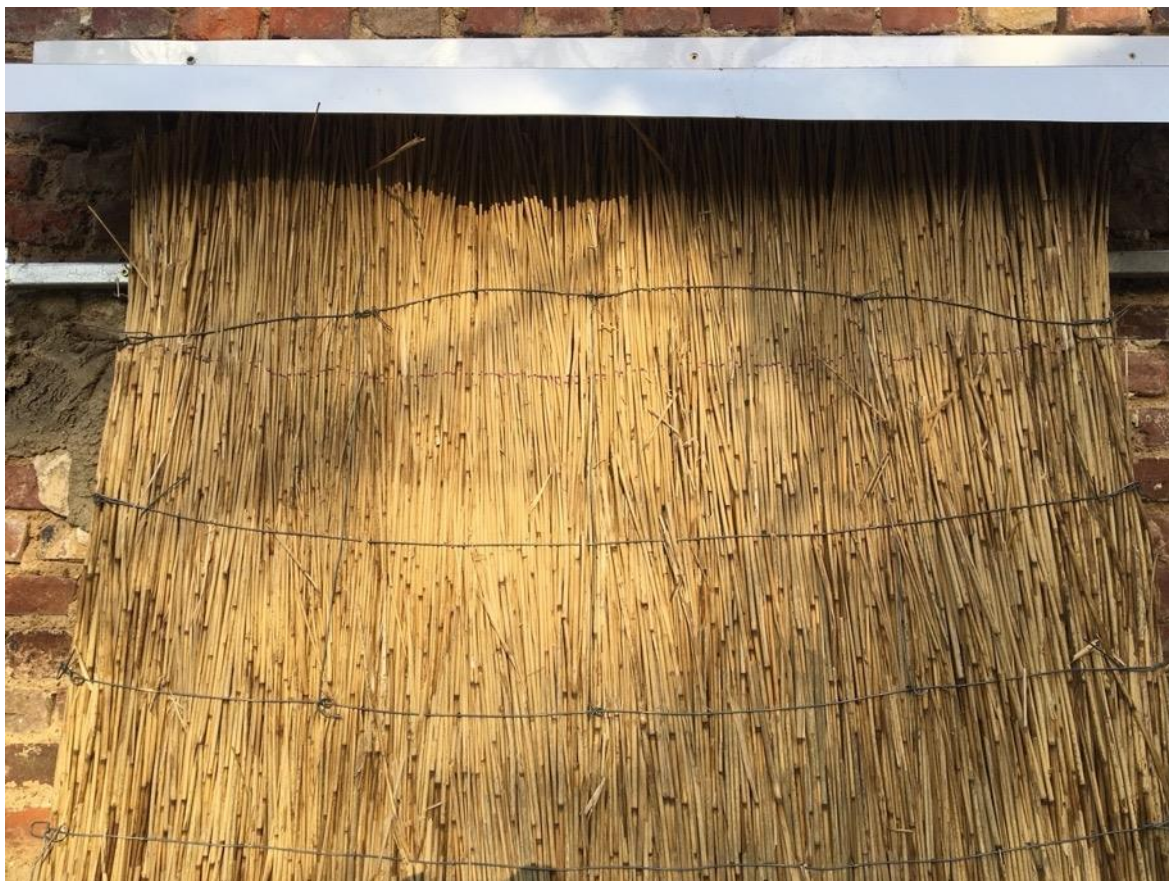
Figure 239 : Déformation du premier prototype, 15/12/20, crédit Carole Lemans
