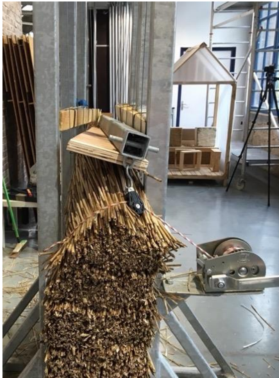
Figure 205 : Première compression du préprototype, 27/11/20, crédit Carole Lemans
