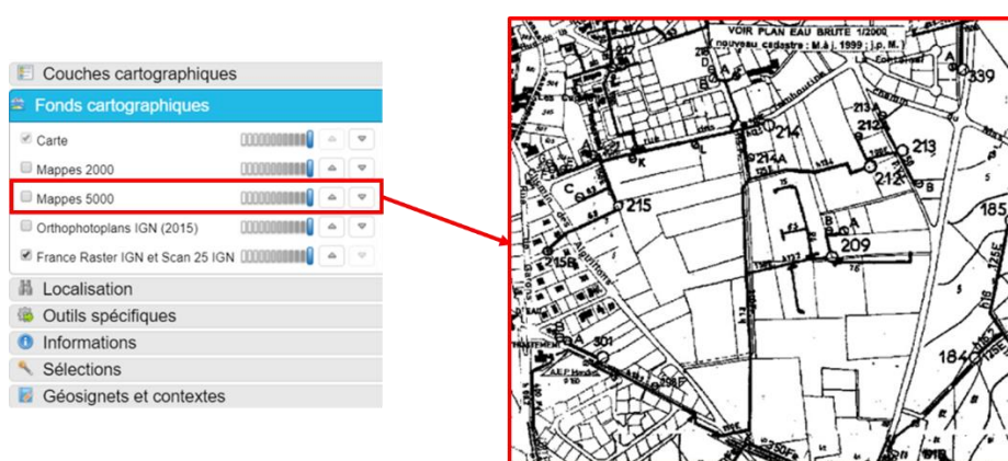
Figure 6. Couche SIG du cadastre ancien géoréférencé
