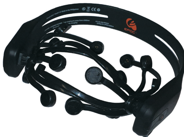
Figure 3.3. Emotiv EPOC EEG helmet.
