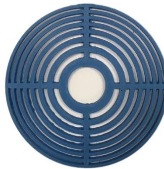
Figure 4 – Lentille acoustique en bioplastique PLA (acide polylactique), d'après (Tarrazó-Serrano et al., 2019).
