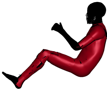
(a) Surface (en rouge) soumise à l'onde de surpression dans la simulation
