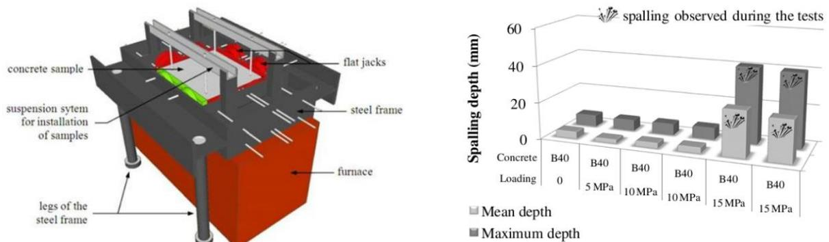
**Figure 1.7** – Evolution de la profondeur moyenne et maximale d'écaillage pour différents taux de compression uniaxiale [Carré et al. 2013]
