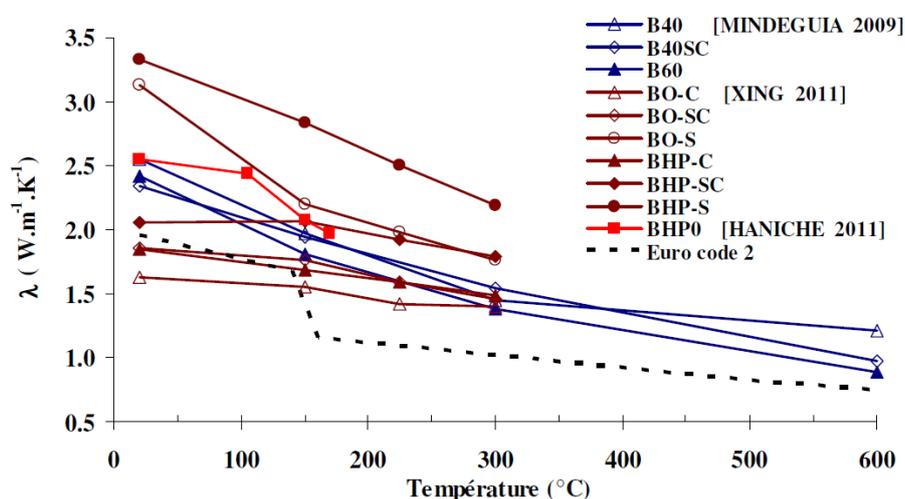
**Figure 5.4** – Evolution de la conductivité thermique en fonction de la température pour des bétons BHP, BO. C : pour granulats calcaires et SC : granulats silico-calcaires [Mindeguia 2009; Xing et al. 2011; Haniche 2011]. Citée dans [Nguyen 2013]
