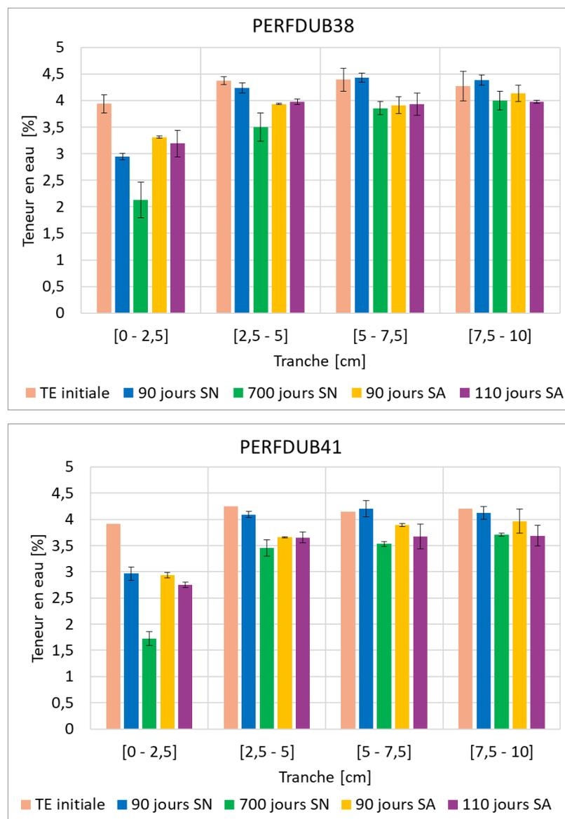
**Figure 6.21** – Comparaison du profil hydrique cible à 700 jours en SN au profil hydrique obtenu à 90 jours SN, 90 jours SA et 110 jours en SA dans les BHP
