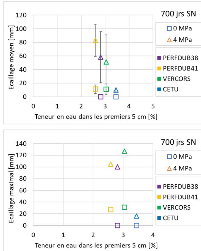
**Figure 6.12** – Influence du chargement sur l'évolution de la profondeur d'écaillage en fonction de la teneur en eau moyenne dans la zone d'intérêt à 700 jours SN
