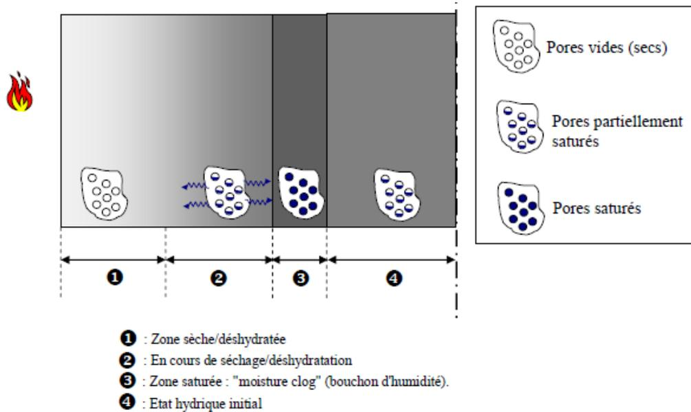
**Figure 1.2** – Processus de formation du bouchon hydrique [Mindeguia 2005]
