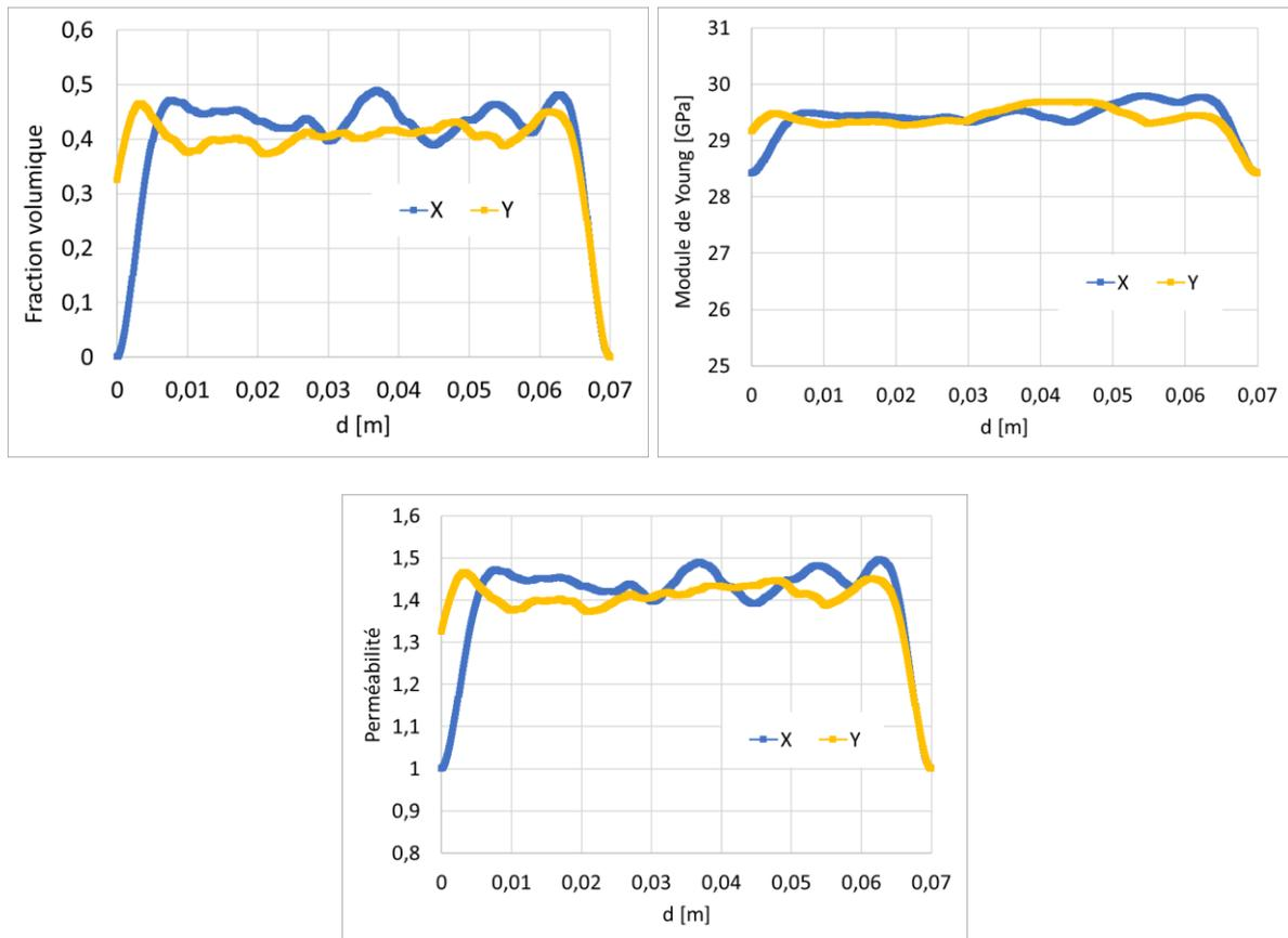
**Figure 13** – Evolution évolution de la fraction volumique des granulats, du rapport de perméabilité et du module de Young dans la direction x dans une éprouvette  $7 \times 7 \times 28 \text{ cm}^3$  (configuration réelle de coffrage) sans application de la pesanteur.  $Y = 0$  présente le côté non moulé de l'éprouvette
