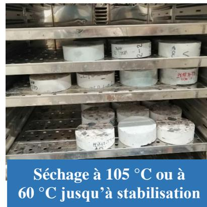
**Figure 3.16** – Mesure de la porosité accessible à l'eau
