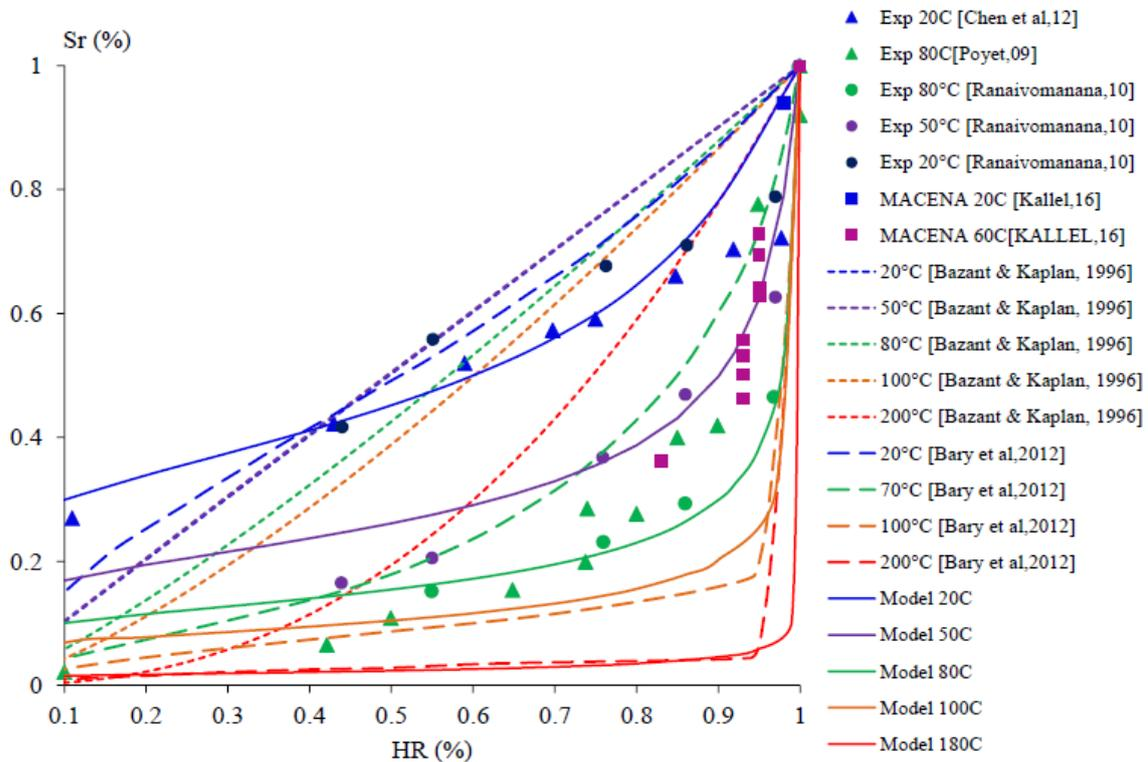
**Figure 5.11** – Restitution des courbes d'isotherme de désorption (numériques et expérimentales) à différentes températures en utilisant le modèle proposé par [Chhun 2017] présentés par les traits continus. Les marques présentent les mesures expérimentales de [Poyet and Charles 2009; Chen et al. 2012; Ranaivomanana et al. 2011], les traits interrompus présentent les résultats de simulation proposée par [Bazant and Kaplan 1996] et [Bary et al. 2012]
