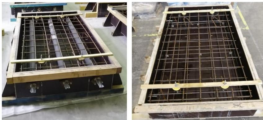
**Figure 6.1** – Coffrage des dalles. A droite, coffrage adapté au chargement par post-tension et à gauche sans chargement
