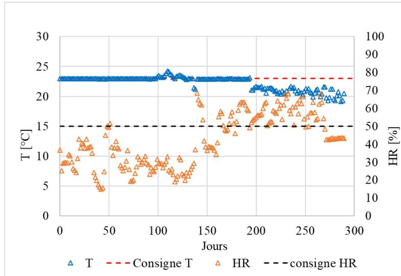
**Figure 4.19** – Evolution de la température et de l’humidité relative pour le séchage en conditions normalisées dans la salle climatique. Mesures réalisées à l’aide une sonde T/HR placée à côté des échantillons
