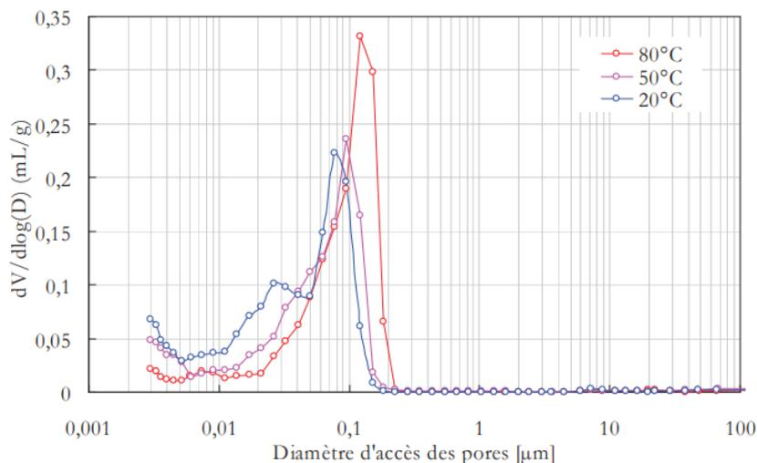
**Figure 5.7** – Evolution de la distribution de la taille des pores obtenue par intrusion au mercure dans des pâte de ciment (CEM I) à E/C = 0,4 pour des températures de conditionnement différentes [Drouet 2010]
