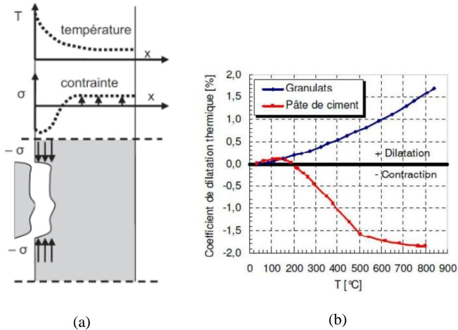
**Figure 1.1** – (a) La dilatation empêchée dans le béton [Bazant et Thonguthai 1978]. (b) évolution du coefficient de dilatation thermique en fonction de la température pour la pâte de ciment et le granulat [Nahhas 2004]
