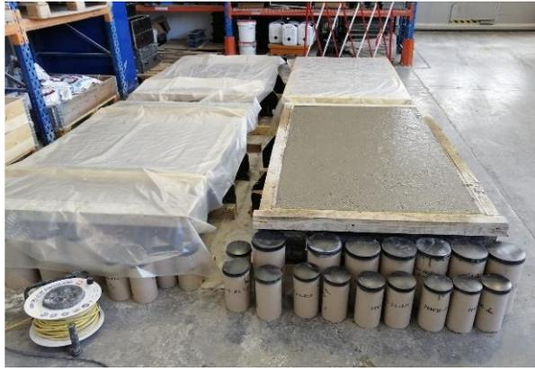
**Figure 6.2** – Coulage des dalles et des éprouvettes représentatives
