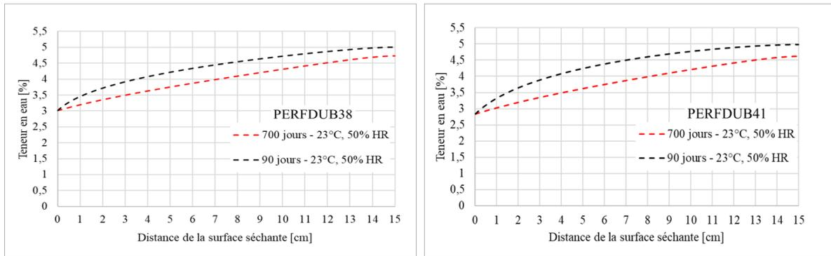
**Figure 5.23** – Modélisation du profil hydrique dans les bétons PERFDUB38 et 41 dans le cas d'un séchage en conditions normalisées (23 °C, 50 %HR) à 2 échéances : 90 jours et 700 jours
