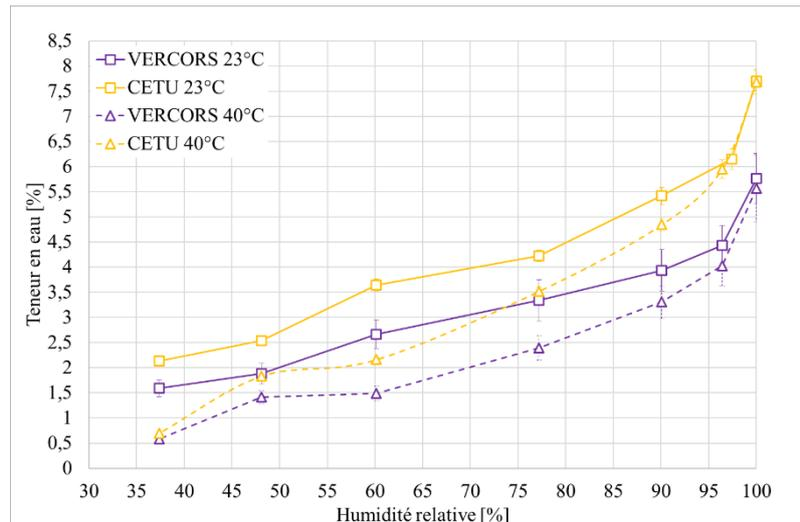
**Figure 4.16** – Isotherme de désorption mesuré à 23 °C et à 40 °C dans les BO
