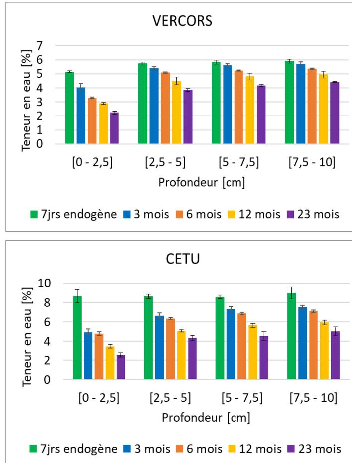
**Figure 6.6** – Evolution du profil hydrique des bétons VeRCoRs et CETU au cours du temps en séchage en conditions normalisées
