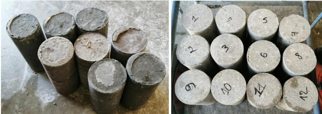
**Figure 3.10** – Rectification des surface libres des échantillons
