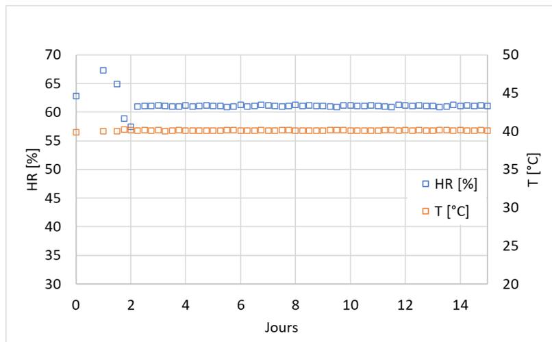
**Figure 6.14** – Evolution enregistrée de la température et de l'humidité relative du séchage accéléré 15 jours à 40 °C, 65 %HR
