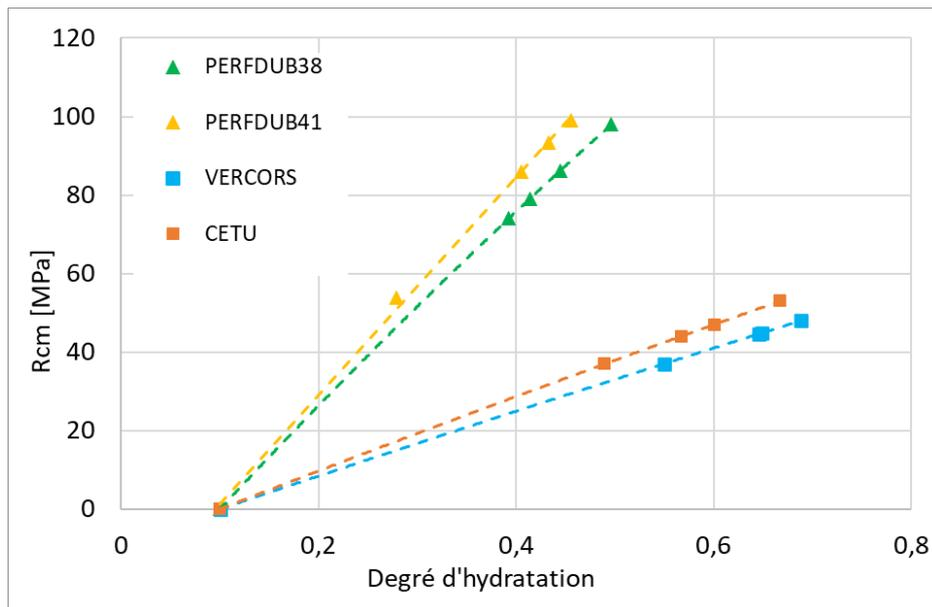
**Figure 3** – Evolution de la résistance en compression en fonction du degré d'hydratation
