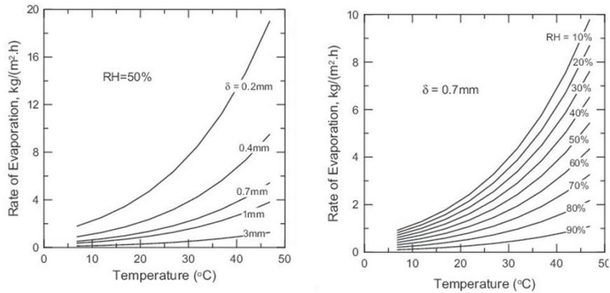
**Figure 5.1** – Evolution du taux d'évaporation en fonction de la température et de la couche limite à 50 %HR (à droite). Evolution du taux d'évaporation en fonction de la température pour différentes humidités relatives, la couche limite est égale à 0,7 mm [Bakhshi et al. 2012] (à gauche)
