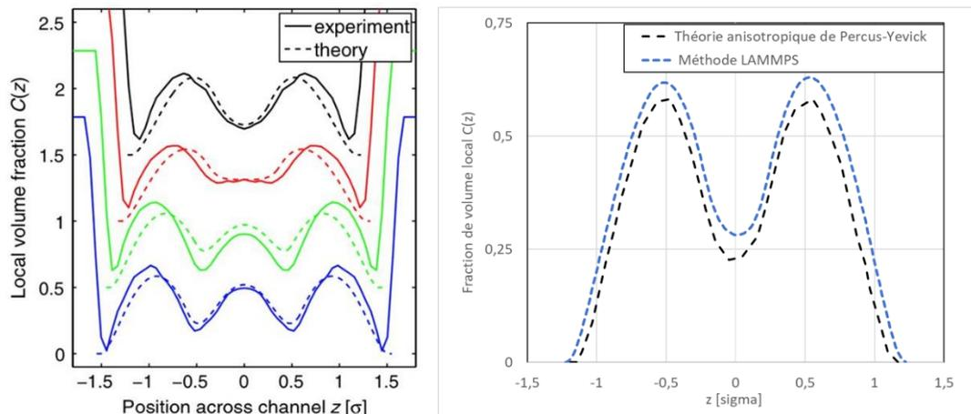
**Figure 8** – Evolution de la fraction volumique des particules nanométriques  $D = 69,2$  nm dans la direction confinée de largeur  $L = 2,45 D$  estimée par [Nygård et al. 2012] par rapport à la méthode LAMMPS
