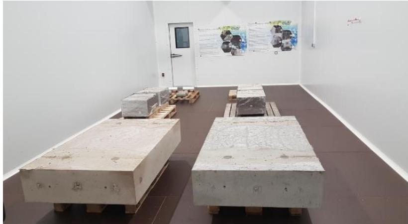
**Figure 6.13** – Séchage à 40 °C ± 2 °C, 65 %HR ± 5 %HR dans une enceinte climatique 10 m<sup>3</sup> à Ater Métrologie
