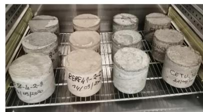
**Figure 4.18** – Perte en masse par séchage parasite dans les échantillons pendant la conservation en condition endogène. A droite, les échantillons Ø 11 x 10 cm placés dans l'enceinte climatique
