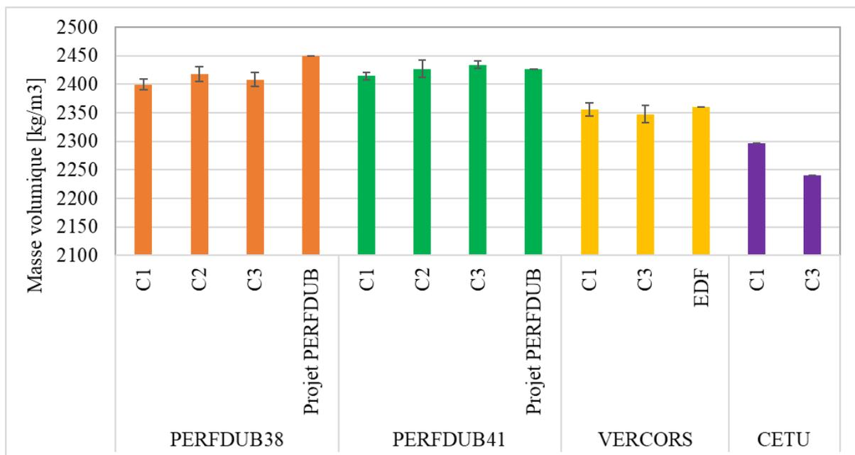
**Figure 3.8** – Comparatif des résultats de masse volumique des bétons à l’état frais pour toutes les fabrications avec les données références pour les bétons PERFDUB et VeRCoRs
