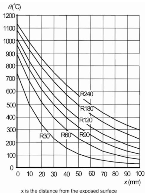
**Figure 5.26** – Profil de température dans des dalles en bétons à granulats siliceux dans le cas d’une exposition au feu type ISO 834 pendant 240 minutes selon l’Eurocode 2 (Partie 1-2 Annexe A) [CEN 2004]
