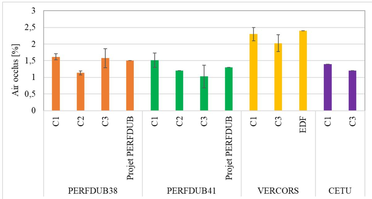
**Figure 3.7** – Comparatif des résultats d’air occlus des bétons à l’état frais pour toutes les fabrications avec les données références pour les bétons PERFDUB et VeRCoRs
