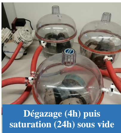
Figure 3.16 – Mesure de la porosité accessible à l'eau
