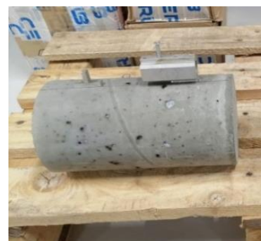
Mise en place des plots sur l'échantillon permettant de fixer le capteur LVDT
