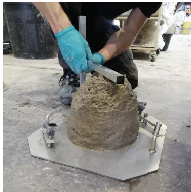
Figure 3.3 – Essai d'affaissement au cône d'Abrams selon la norme NF EN 12350-2 [AFNOR]
