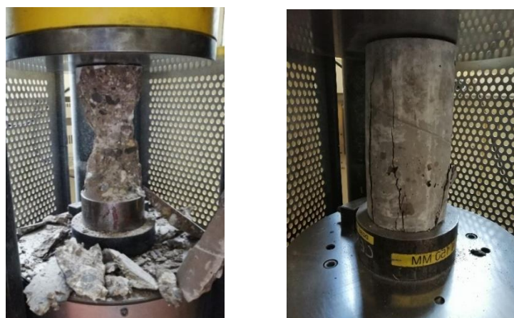
Figure 3.11 – Modes de rupture observés : à droite mode de rupture des bétons PERFDUB, à gauche dans les bétons VeRCoRs et CETU
