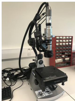
Figure 4.23 – Microscope numérique Keyence utilisé pour la visualisation des microfissurations en surface
