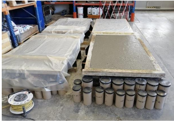
Figure 6.2 – Coulage des dalles et des éprouvettes représentatives
