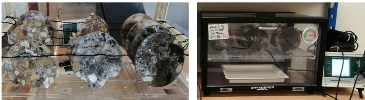
Figure 4.2 – Essai d'isotherme de désorption sur des tranches de 5 \text{ mm} \pm 2 \text{ mm} d'épaisseur – méthode de la solution saline saturée
