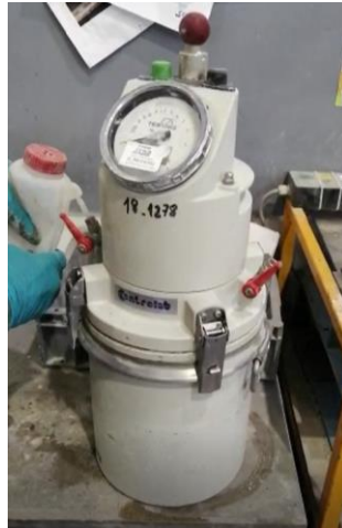
Figure 3.4 – Essai d’air occlus selon la norme NF EN 12350-7 [AFNOR 2019a]
