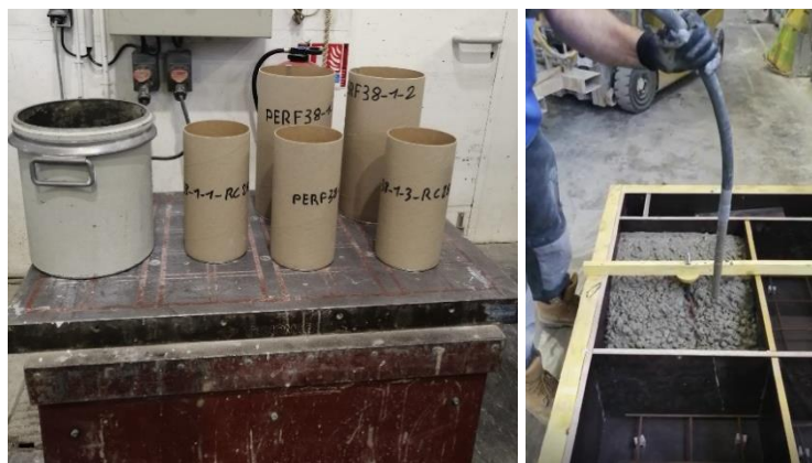
Figure 3.5 – Vibration à l’aide d’une table vibrante pour les éprouvettes et d’une aiguille vibrante pour les dalles
