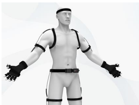
FIGURE 2.4 – Système ambulant permettant de mesurer la cinématique du corps humain à partir des centrales inertielle. Source (irsst.com)
