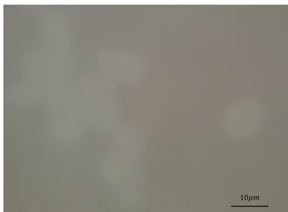
FIGURE 93 – Image optique d'un échantillon recuit à 875 \text{ }^\circ C pendant 1 h . On observe des zones plus claires, qui présentent des pics Raman plus intenses que les zones sombres.
