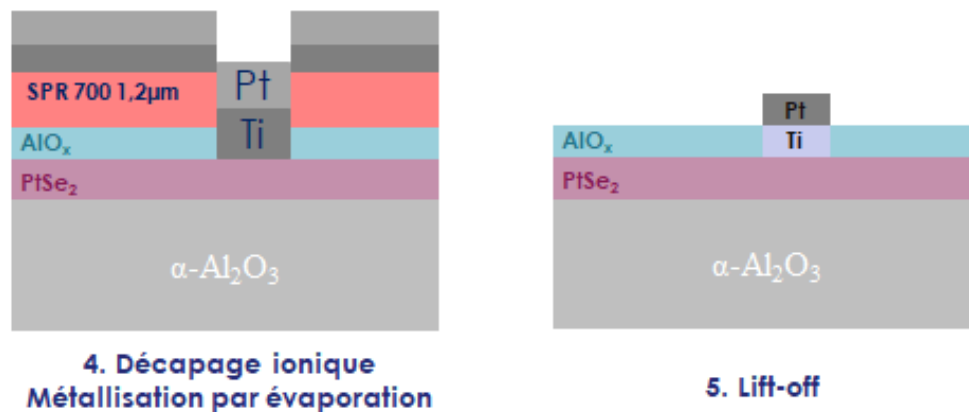
FIGURE 64 – Suite de l’étape 1 de dépôt des marques d’alignement.
