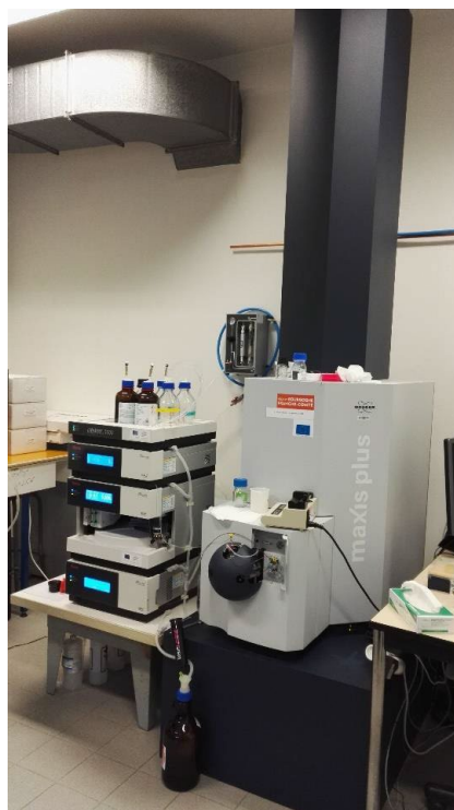
Figure 37 : Spectromètre de masse UPLC-Q-TOF-MS : UHPLC Dionex Ultimate 3000 (ThermoFisher) couplée au spectromètre de masse Maxis plus MS ESI-Q-TOF (Bruker)
