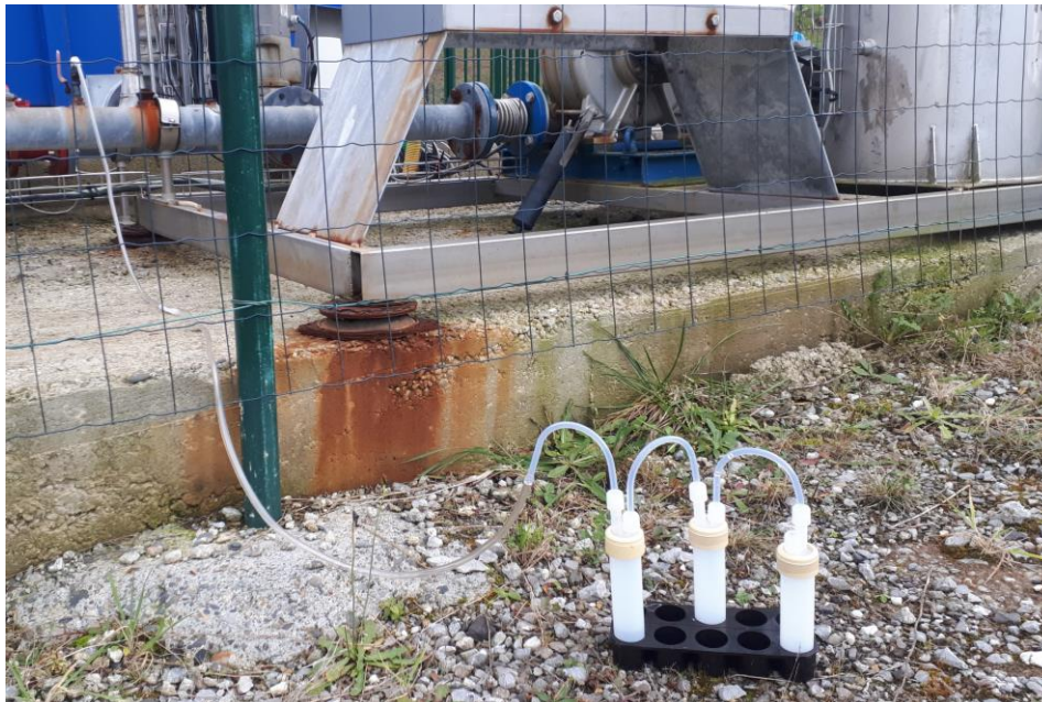
Figure 21. Système de barbotage mise en place sur le site de Mendixka pour la détermination de la concentration en As total dans le biogaz.
