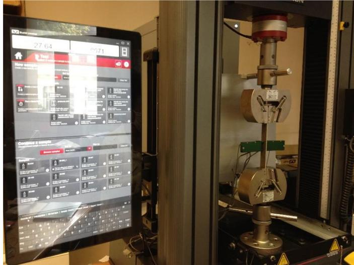
Figure 89 : Montage Instron quasi-statique – Epruvette rectangulaire selon la norme 527-4 équipée d'un extensomètre bidimensionnel
