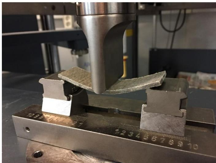
Figure 155 : Montage de flexion quasi-statique sur éprouvette rectangulaire
