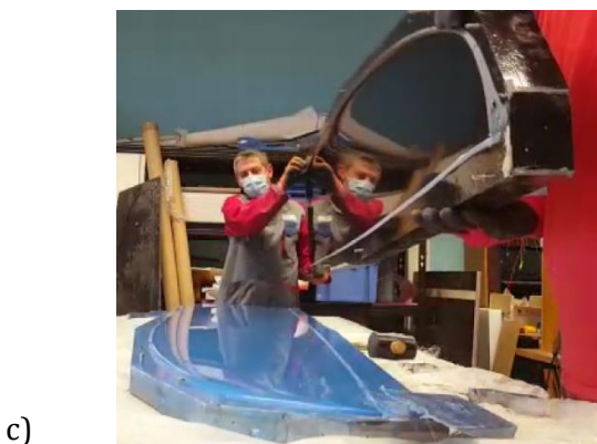
Usinage des moules du drone : a) Usinage des masters en bois MDF (Lycée Couffignal – Strasbourg) ; b) Réalisation du moule négatif – Application du gelcoat ; c) Démoulage du moule négatif du master usiné ; d) Moule négatif de l'extrados droit
