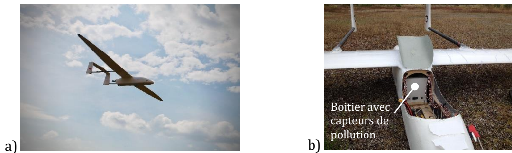
Figure 1 : a) Drone prototype Stork en vol ; b) Intégration des capteurs météo et de pollution dans le fuselage
