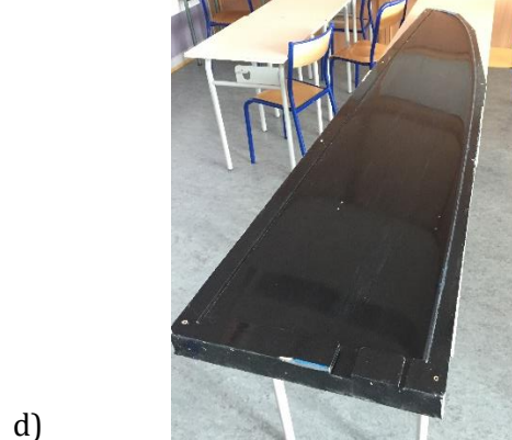
Usinage des moules du drone : a) Usinage des masters en bois MDF (Lycée Couffignal – Strasbourg) ; b) Réalisation du moule négatif – Application du gelcoat ; c) Démoulage du moule négatif du master usiné ; d) Moule négatif de l'extrados droit
