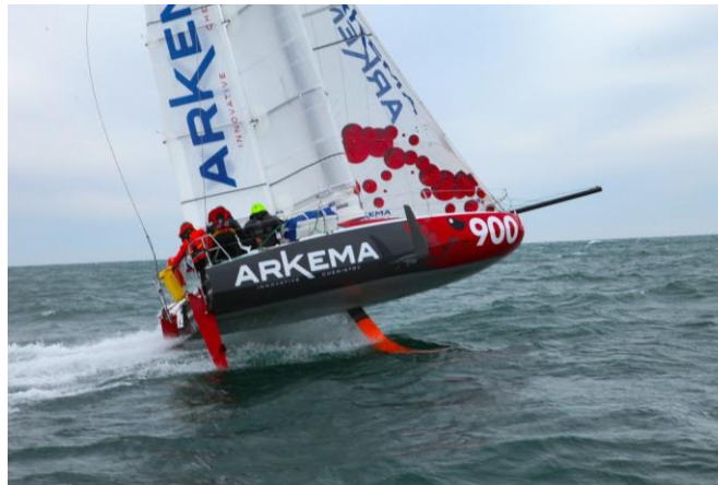
Figure 4 : Hydrofoils permettant la sustentation du navire (Mini 6.50 Arkema) [10]
