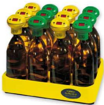
Figure 48. Le système de mesure de la DBO utilisé dans le laboratoire ainsi que le support d'agitateur OxiTop® IS 12
