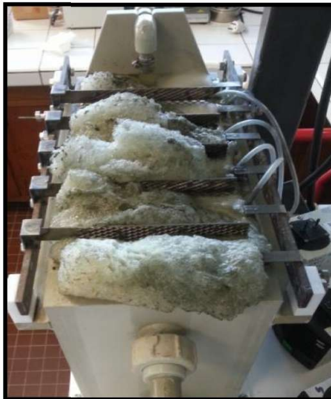
Figure 101. Photographies de la mousse formée lors du traitement de BPA par le procédé électro-Fenton à l'échelle semi-pilote avec l'utilisation de l'oxygène comme source de barbotage
