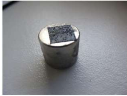
Fig. 13 : Cliché d'une poudre noire collée sur du scotch carbone lui-même collé sur un plot en aluminium pour la mesure au MEB.
