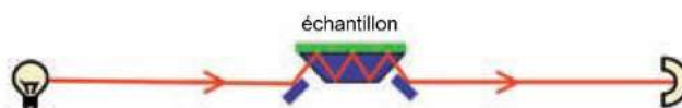
Fig. 15 : Montage de réflexion totale atténuée (ATR) : un prisme de fort indice de réfraction dans l'IR est au contact d'un échantillon.
