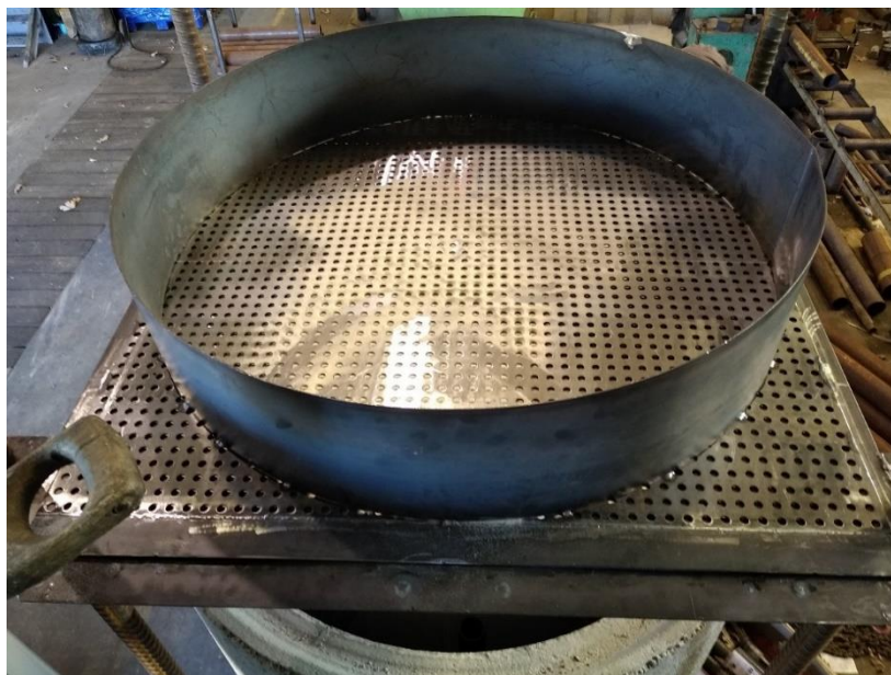
Figure II-16. Réservoir supérieur reposant sur le système de sas.
