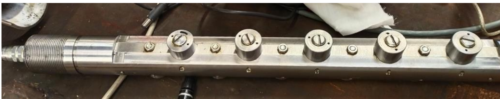
Figure I-25 : Pistons en position de course maximale.
