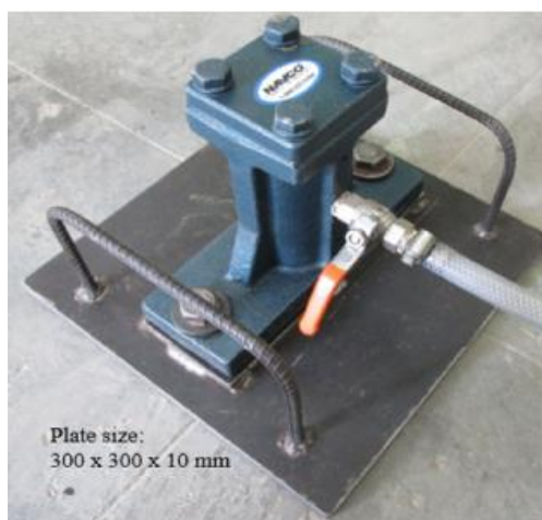
Figure II-12. Exemple de méthode de compactage par vibration. D'après Hariprasad et al., 2016.
