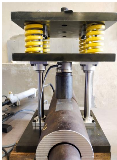
Figure I-52 : Essais sur 4 ressorts de type B avec le prototype 3a.
