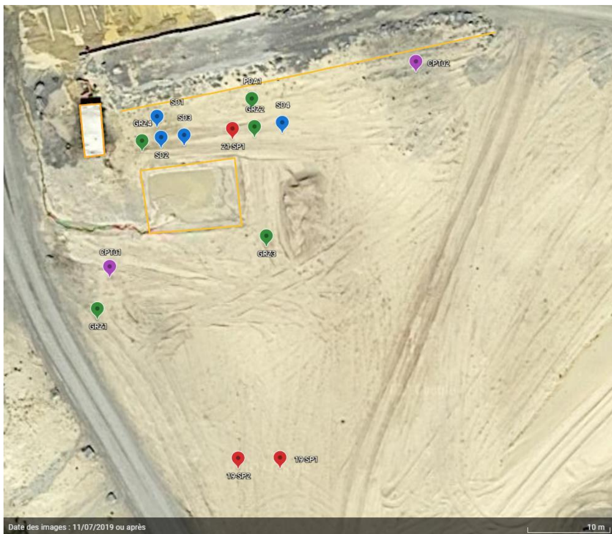
Figure E-1. Plan d'implantation (Messanges). En bleu : sondages au Dilatosol (SD). En rouge : sondages pressiométriques (SP). En vert : sondages au pénétromètre dynamique lourd (GRZ) et léger (PDA). En violet : Sondages au piézocône (CPTu).
