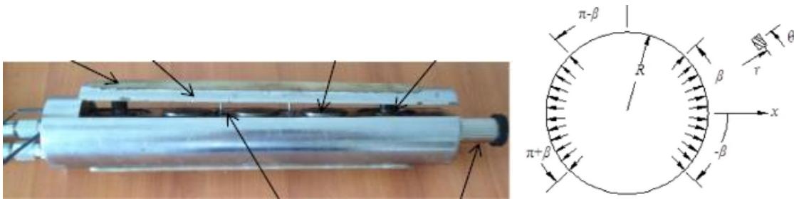
Figure I-18 : Dilatomètre rigide modifié, d'après (Zhang et al., 2016). À gauche : vue générale. À droite : géométrie de chargement considéré.
