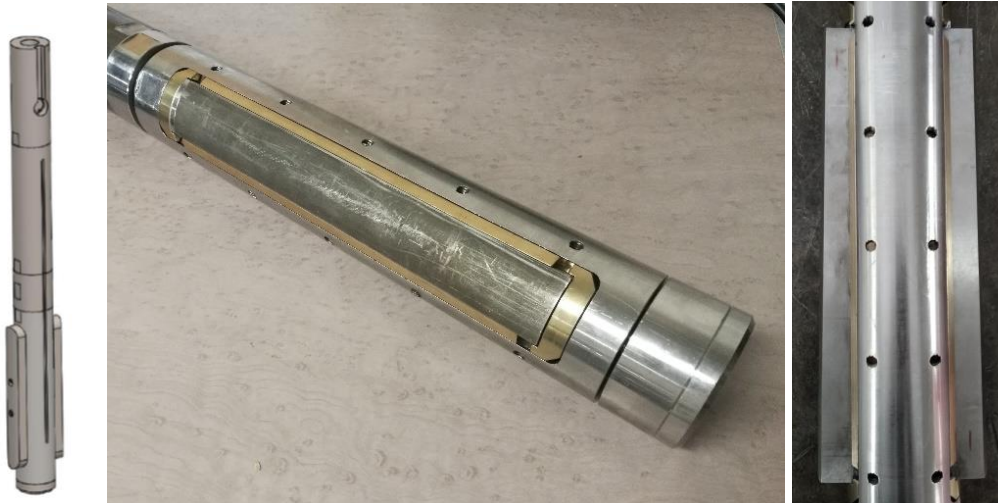
Figure I-19 : A gauche : Schéma général du prototype 1 avec les coquilles ouvertes. Au milieu : Prototype 1 avec les coquilles rétractées. À droite : Coquilles en position d'écartement maximal.
