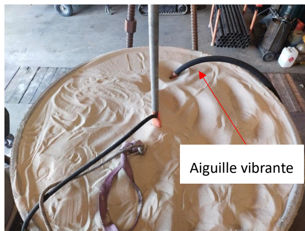
Figure II-22. Compactage du massif sableux à l'aiguille vibrante.
