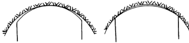
Figure III-20 : Analyse du problème du contact coquille/paroi d'après Hustrulid (1976). À gauche : rayon de forage supérieur au rayon de courbure des coquilles. À droite : rayon de forage inférieur au rayon de courbure des coquilles.
