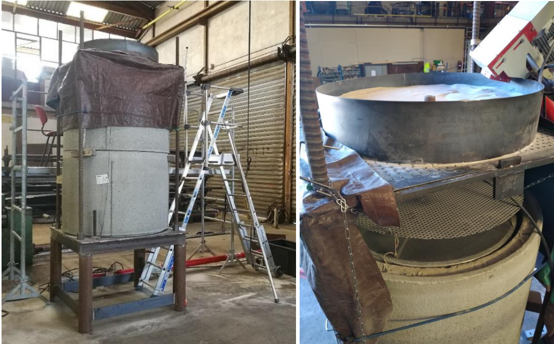
Figure II-17. À gauche : vue extérieure de la chambre d'essais protégée d'une bâche lors de la pluviation. À droite : Le diffuseur.
