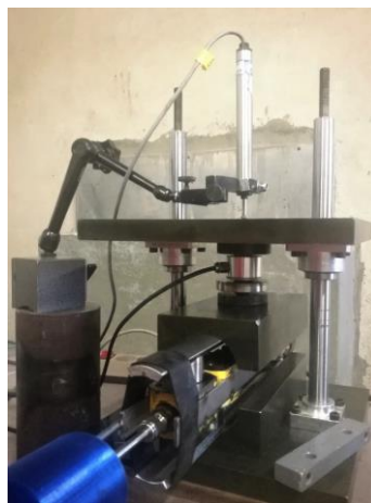
Figure I-34 : Étalonnage du déplacement pour le prototype 2.
