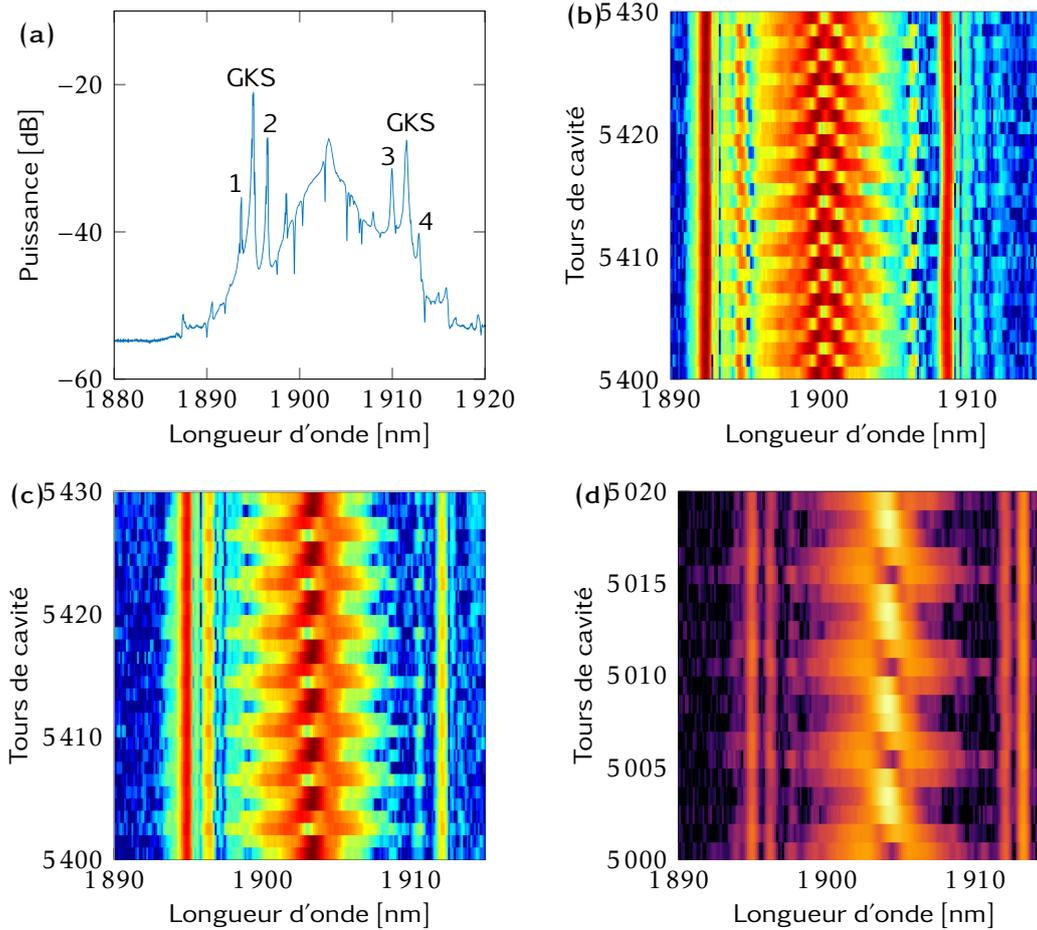
FIGURE 3.10 – **Solitons multi-périodes** : (a) Spectre optique correspondant à (b) et montrant les instabilités de modulation (MI) qui se développe autour des bandes latérales de Gordon-Kelly. (b,c,d) évolutions des spectres DFT pour trois régimes impulsifs différents, montrant que le spectre du soliton évolue avec des périodes régulières, respectivement, de 3, 4 et 5 tours de cavité.
