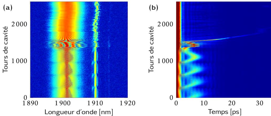
FIGURE 3.11 – **Génération d'un deuxième soliton à partir d'un soliton fondamental oscillant.** (a) Enregistrement des spectres DFT sur plus de 2600 tours de cavité. (b) Évolution de la trace d'autocorrelation (AC) de premier ordre obtenue via la FFT du signal DFT : on observe des oscillations du soliton avec émission de rayonnements jusqu'à 1350 tours, puis la création d'un deuxième soliton à partir de ces rayonnements et qui oscille sur 200 tours avant de se séparer.
