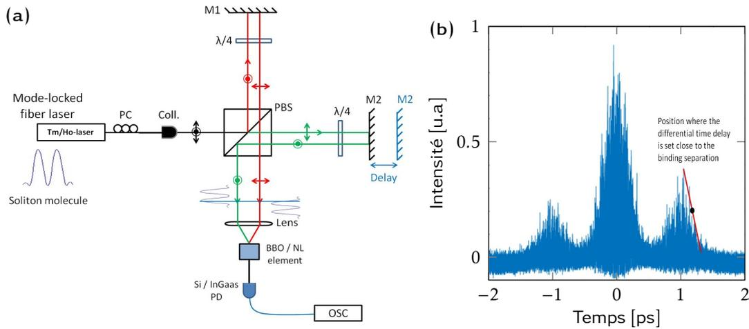
FIGURE 3.19 – (a) Le montage expérimental de la mesure des fluctuations temporelles internes à une molécule de deux solitons générée par le laser à fibre à  $2\mu\text{m}$  : une configuration de corrélation croisée non-linéaire de type II est présentée. (b) Trace d'auto-corrélation typique d'une molécule de deux solitons obtenue avec l'auto-corrélateur PulseCheck APE. Le point sur la pente représente un point de consigne approprié du délai avant le traitement du signal.
