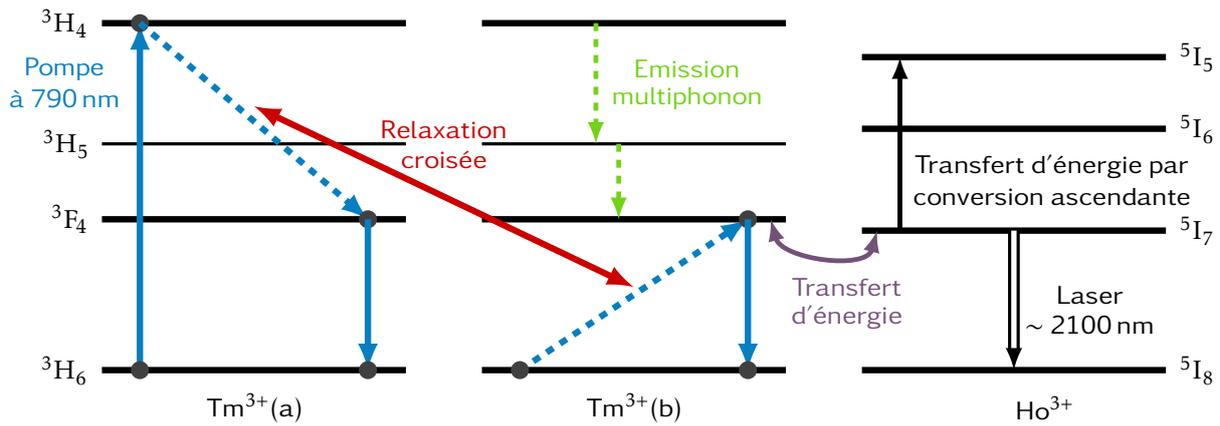
FIGURE 1.15 – Représentation simplifiée des niveaux d'énergie d'une fibre en silice codopée aux ions  $\text{Tm}^{3+}$  et  $\text{Ho}^{3+}$ . Le schéma montre la pompe à 790 nm, le phénomène de relaxation croisée, le transfert d'énergie du niveau  ${}^3\text{F}_4$  du thulium au niveau  ${}^5\text{I}_7$  de l'holmium, le transfert d'énergie par conversion ascendante, un exemple d'émission multiphonon ainsi que les processus laser.
