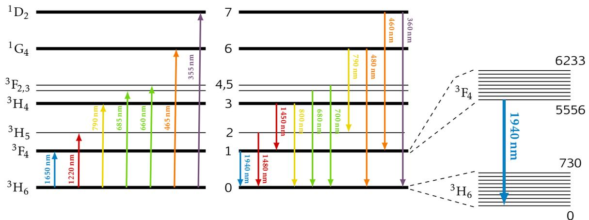
FIGURE 1.10 – Caractéristiques de l'ion thulium : diagramme énergétique des 8 premières bandes d'énergie de l'ion  $Tm^{3+}$  dans une matrice de silice et les longueurs d'ondes d'absorption (à gauche) et d'émission (au milieu) des niveaux respectifs. La dégénérescence en sous-niveaux par effet Stark est représentée à droite montrant l'émission laser autour de 1940 nm, l'échelle verticale représente l'énergie en  $\text{cm}^{-1}$ .
