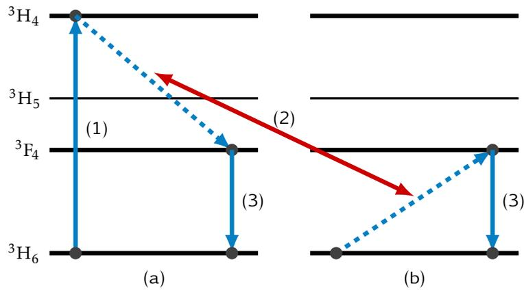
FIGURE 1.11 – Illustration du phénomène de relaxation croisée entre deux ions voisins du thulium. Le pompage à 790 nm permet d'exciter un ion (a) au niveau  ${}^3\text{H}_4$  (1), une partie de l'énergie de l'ion est cédée à un ion voisin (b), se retrouvant tous les deux au niveau  ${}^3\text{F}_4$  via la relaxation croisée (2). Une émission de deux photons autour de  $2\ \mu\text{m}$  est alors obtenue à partir du niveau  ${}^3\text{F}_4$  (3).
