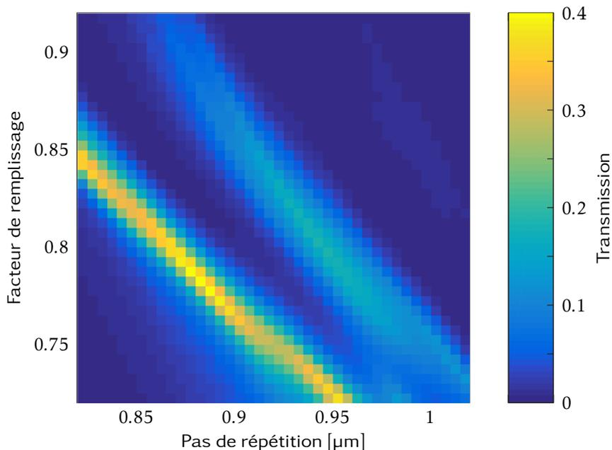
FIGURE 4.9 – Transmission d'un réseau coupleur en SOI composé de 340 nm de Si sur une couche de  $2\ \mu\text{m}$  d'épaisseur de  $\text{SiO}_2$  à la longueur d'onde  $2\ \mu\text{m}$ . Le maximum de transmission est de 40% et est obtenu pour une période de  $a = 0,88\ \mu\text{m}$  et un facteur de remplissage de  $f = 0.78$ .
