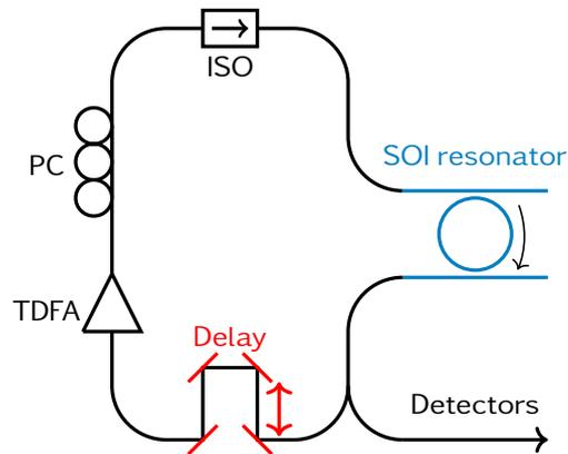
FIGURE 4.1 – Cavité laser fibrée comprenant un amplificateur thulium (TDFA), un contrôleur de polarisation (PC) et un isolateur (ISO). L'élément de verrouillage de modes est un résonateur en anneau SOI, et la ligne à retard (Delay) est utilisée pour accorder la longueur de la cavité fibrée à celle du résonateur. La sortie laser est extraite via un coupleur fibrée et est envoyée vers les appareils d'analyse.
