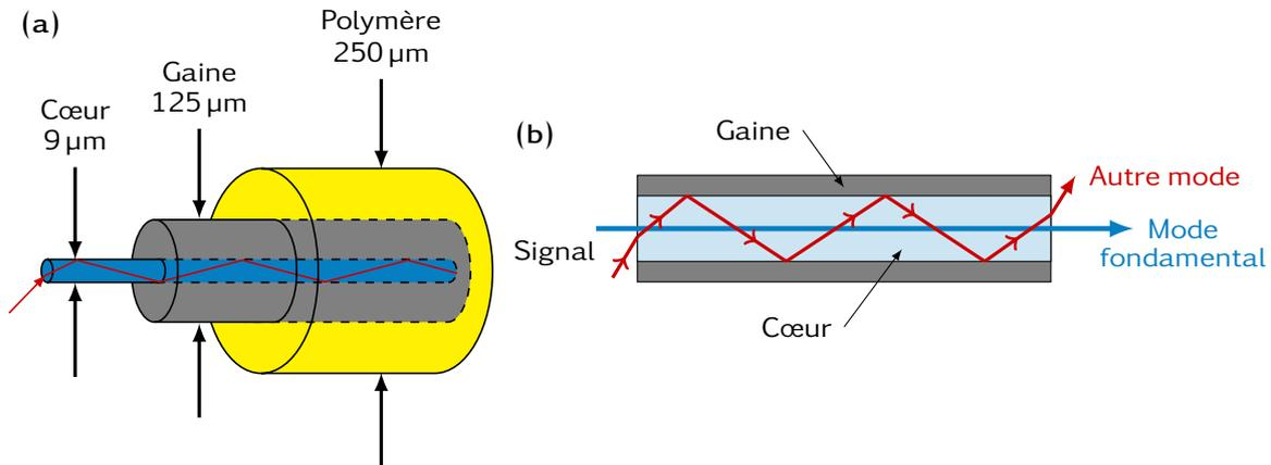
FIGURE 1.1 – (a) Représentation schématique d'une fibre optique; (b) guidage de la lumière dans une fibre optique : en bleu, représentation schématique du mode transverse fondamental LP<sub>01</sub> transmis par une fibre monomode; et en rouge, schématisation d'un mode d'ordre supérieur qui peut être transmis par une fibre multimode.
