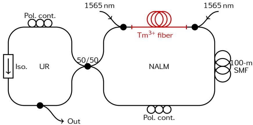
FIGURE 3.7 – **Le dispositif expérimental NALM** : la boucle amplificatrice non-linéaire est composée d'une fibre dopée au thulium de 3 m de long pompée par deux signaux 1 W à 1565 nm via deux multiplexeurs 1600/2000 nm, de 100 m de fibre monomode (SMF) et d'un contrôleur de polarisation. L'autre boucle (UR) est composée d'un contrôleur de polarisation, d'un isolateur qui impose le sens de propagation et d'un coupleur pour extraire le signal.
