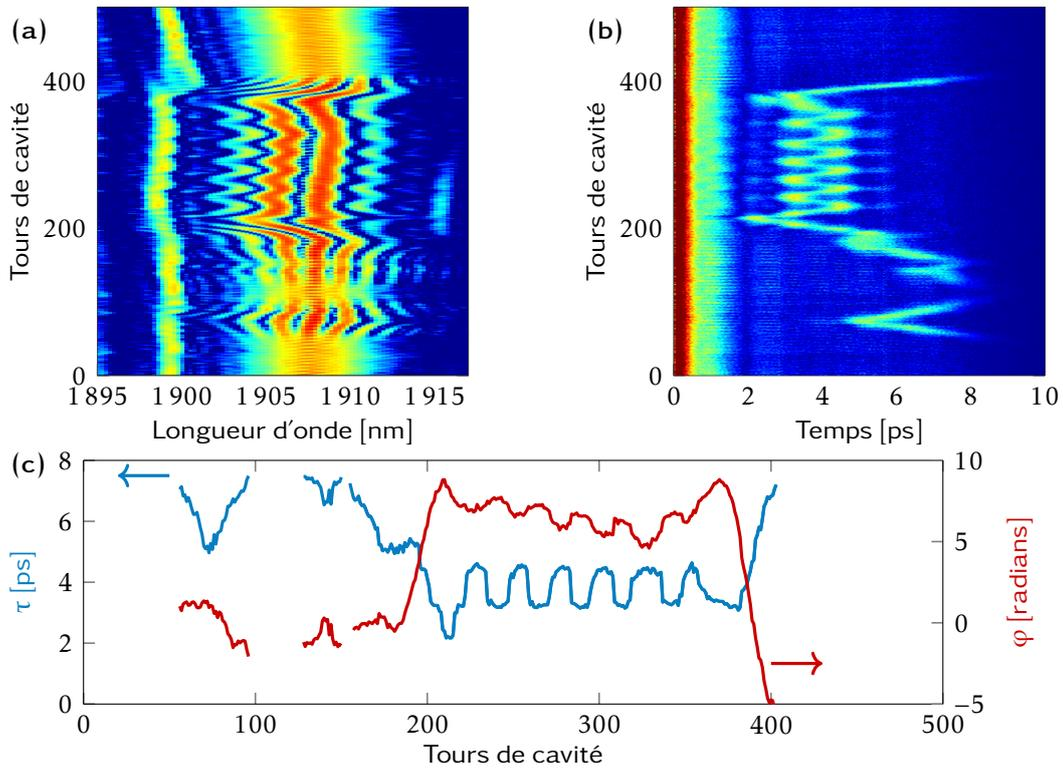
FIGURE 3.16 – **Mouvements erratiques et vibrations au sein d’une molécule de deux solitons** : (a) spectres DFT montrant l’apparition, la déformation (vibration) et la disparition erratiques des franges spectrales; (b) évolution de la trace d’autocorrelation (AC) de premier ordre; et and (c) évolutions de la séparation temporelle  $\tau$  (bleu, gauche) et de la phase relative  $\phi$  (rouge, droite) entre les deux solitons.
