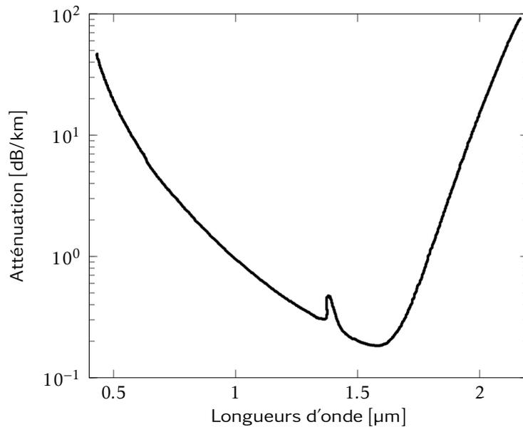
FIGURE 1.4 – Extension du spectre d’atténuation typique de la silice jusqu’à 2,2  $\mu\text{m}$ . La bande d’absorption à 1,39  $\mu\text{m}$ , liée aux radicaux -OH, est supprimée dans les fibres actuelles grâce aux développements récents des techniques de fabrication de préformes, d’après [26].
