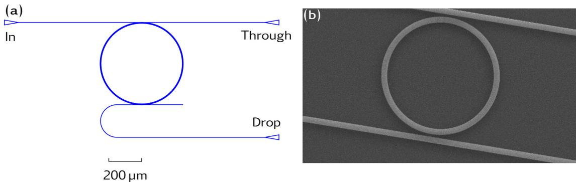
FIGURE 4.11 – (a) Design d'un microring composé de guides rubans et montrant les différents ports de couplage *In*, *Through* et *Drop*. (b) Image obtenue par Microscopie à Balayage Électronique (MEB) du microring composé de guides d'onde en SOI. Ces dimensions sont :  $R = 10 \mu\text{m}$ ,  $e = 340 \text{ nm}$ ,  $w = 1,2 \mu\text{m}$  et  $g = 0,5 \mu\text{m}$ ,  $R$  et  $g$  étant respectivement le rayon du résonateur et le gap entre le résonateur et le guide d'onde.
