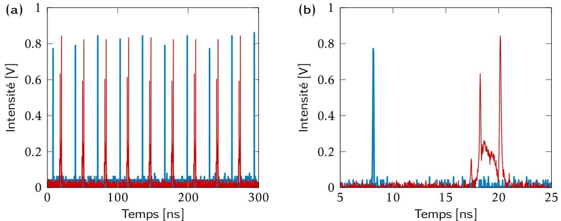
FIGURE 3.2 – Caractérisation expérimentale d'un train d'impulsions sur quelques tours d'une cavité laser : (a) traces temporelles directement en sortie du laser (bleu) et après propagation dans le milieu dispersif (rouge). (b) Zoom sur un tour de cavité montrant une impulsion unique avec le spectre correspondant obtenu via le dispositif de la transformée de Fourier dispersive DFT.
