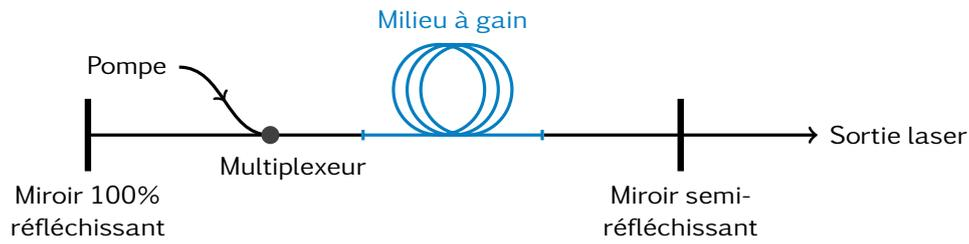
FIGURE 1.8 – Principe d'un laser à fibre : architecture d'une cavité Pérot-Fabry. La pompe est injectée via le multiplexeur. Un miroir semi-réfléchissant est utilisé pour extraire le signal de sortie.
