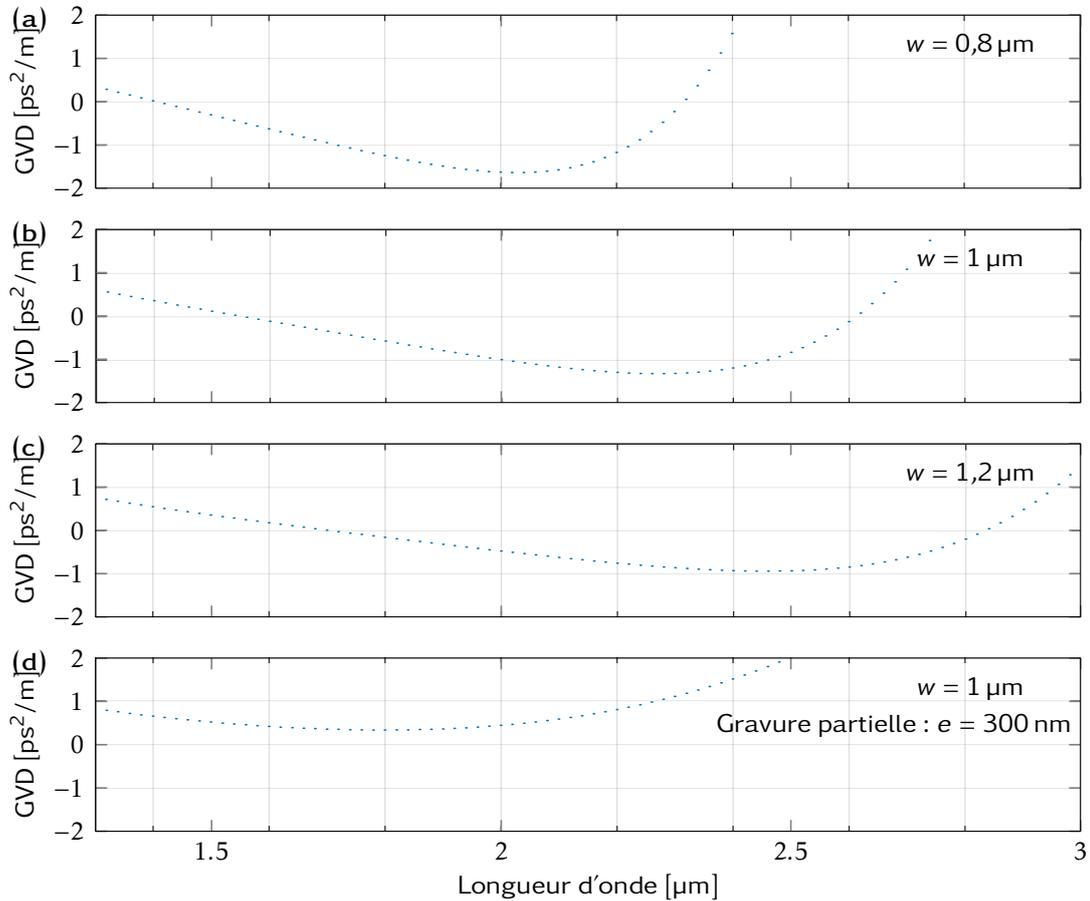
FIGURE 4.7 – Calculs de la dispersion de vitesse de groupe GVD autour de la longueur d'onde  $2\ \mu\text{m}$  en fonction de l'épaisseur  $e$  et la largeur  $w$  d'un guide d'onde ruban en verre de chalcogénure ( $\text{GeS}_2$ ) sur une couche de  $\text{SiO}_2$  d'épaisseur  $3\ \mu\text{m}$ . (a,b,c) Gravure totale de la couche de chalcogénure ( $e = 480\ \text{nm}$ ) et (d) gravure partielle ( $e = 300\ \text{nm}$ ).
