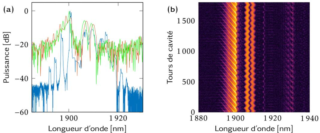
FIGURE 3.18 – **Caractérisation expérimentale d’une molécule oscillante présentant une forte émission périodique de bandes latérales de Gordon-Kelly :** (a) spectre OSA (bleu) et spectres DFT (rouge et vert) correspondant aux extrema d’oscillation de la molécule et (b) enregistrement DFT sur 1800 tours de cavité.
