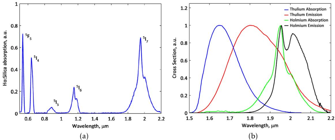
FIGURE 1.14 – Caractéristiques spectroscopiques de l’ion holmium : (a) spectre d’absorption des ions  $\text{Ho}^{3+}$  dans une matrice de silice et les niveaux énergétiques mis en jeu et (b) sections efficaces d’absorption et d’émission des ions  $\text{Tm}^{3+}$  et  $\text{Ho}^{3+}$  dans la silice autour de  $2\ \mu\text{m}$  (de [67]), montrant la possibilité d’étendre la fenêtre d’émission laser au delà de  $2\ \mu\text{m}$  avec les ions  $\text{Ho}^{3+}$ .
