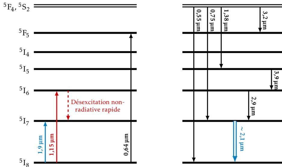
FIGURE 1.13 – Diagramme des 8 premiers niveaux d'énergie de l'ion  $\text{Ho}^{3+}$  dans une matrice de silice : les longueurs d'ondes courantes d'absorption et d'émission des niveaux respectifs sont respectivement représentées à gauche et à droite.
