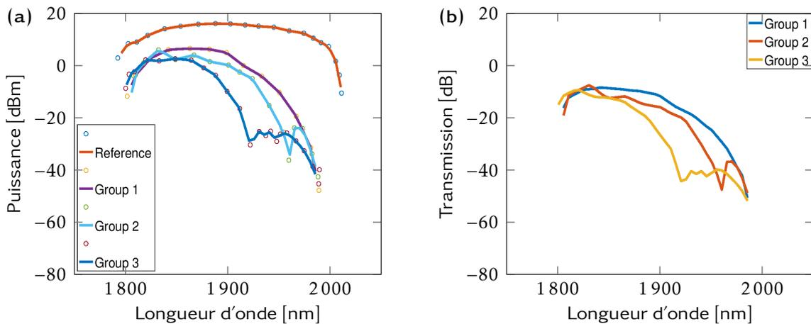
FIGURE 4.19 – (a) Enveloppes spectrales de la référence et des transmissions des guides d’ondes droits de largeur  $2 \mu\text{m}$  des différents groupes 1, 2 et 3. (b) Fonctions de transfert des guides de longueur 1,5 mm et de largeur  $2 \mu\text{m}$ .
