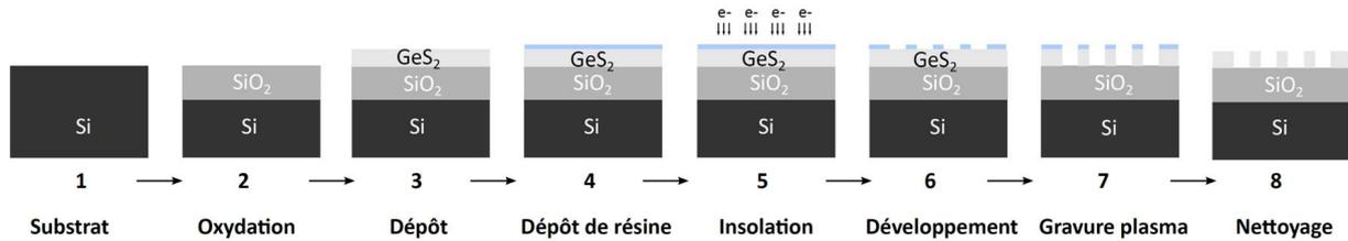
FIGURE 4.5 – **Présentation du procédé de fabrication des des échantillons en verre de chalcogénures** : les différentes étapes allant du substrat de silicium jusqu’à la gravure en salle blanche sont représentées. Notons qu’une dernière étape possible - dépôt de nitrure de silicium au dessus du GeS<sub>2</sub> - n’est pas illustrée. Éditée de [234]
