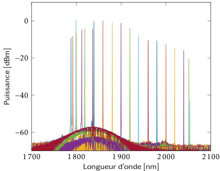
FIGURE 4.13 – Spectres d'émission du laser accordable autour de  $2\ \mu\text{m}$ . La longueur d'onde centrale du laser peut être réglée dans une fenêtre spectrale large de 270 nm entre 1780 nm et 2050 nm.
