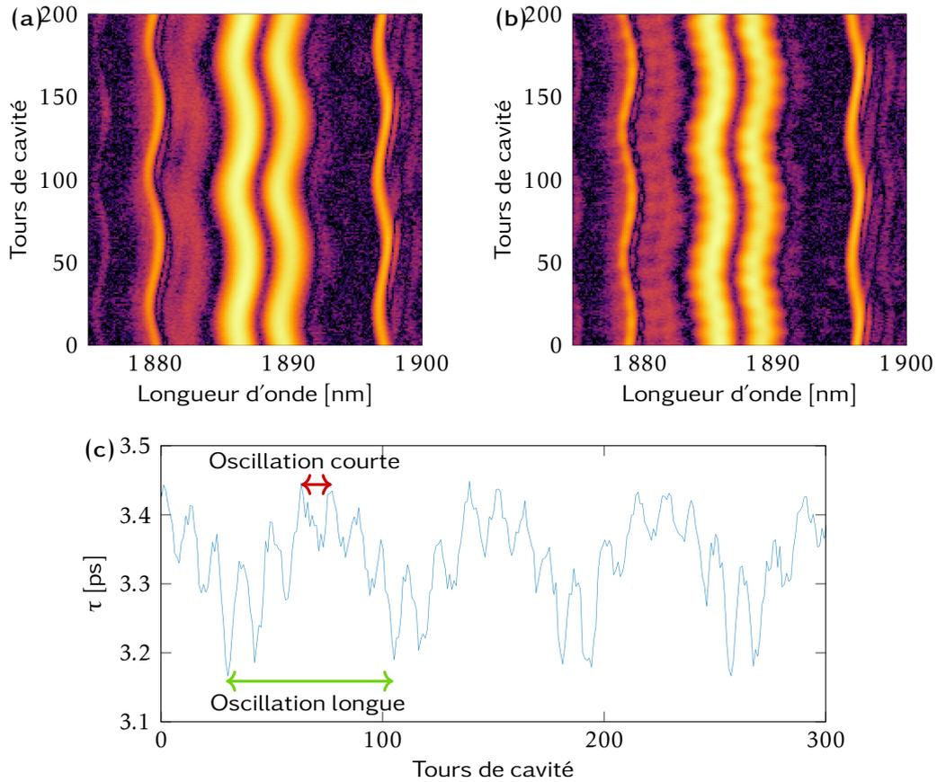
FIGURE 3.17 – **Observation expérimentale des oscillations périodiques multiples au sein d’une molécule de deux solitons** : (a,b) Enregistrement des spectres en temps réel sur 200 tours de cavité : (b) met en évidence les oscillations à 2 périodes obtenues en déstabilisant la molécule de solitons optiques de la figure (a). (c) montre l’évolution de la séparation temporelle entre les deux impulsions de la figure (b), et qui illustre bien la présence de 2 oscillations.
