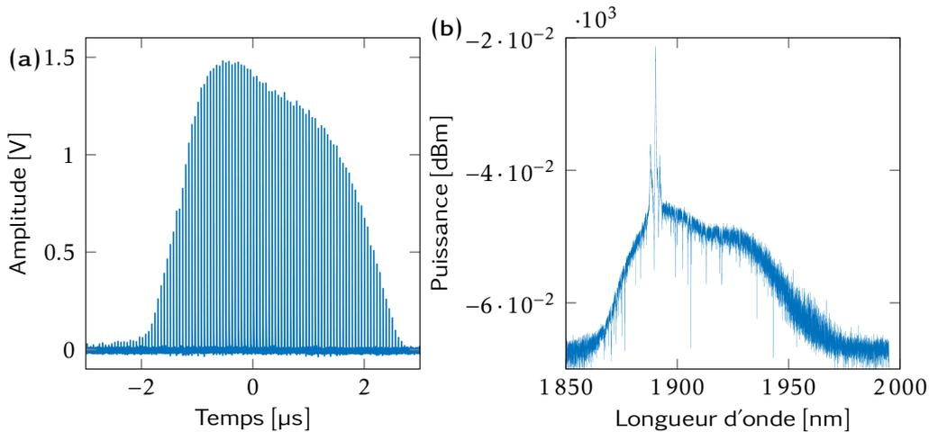
FIGURE 3.23 – (a) Caractéristiques temporelles d’une impulsion QSML isolée obtenue via l’ENLP, évolution temporelle sur 6  $\mu\text{s}$  d’un QSML instable. (b) Exemple de spectre optique mesuré pour un QSML.
