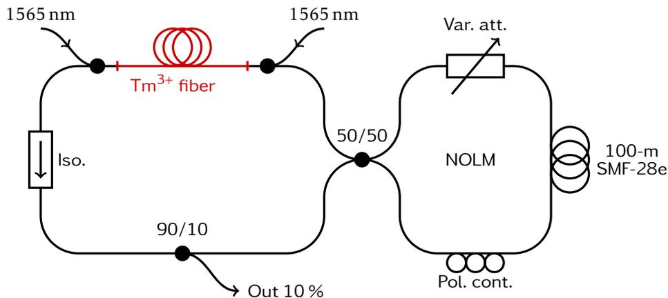
FIGURE 3.6 – **Le dispositif expérimental NOLM** : le gain du laser est assuré par une fibre dopée au thulium de 3 m de long pompée par deux signaux 1 W à 1565 nm via deux multiplexeurs 1600/2000 nm. Un isolateur impose le sens de propagation, et un coupleur 90/10 complète la cavité. L'absorbant saturable effectif est un miroir à boucle non-linéaire (NOLM) composée de 100 m de fibre monomode (SMF), d'un atténuateur variable et d'un contrôleur de polarisation.
