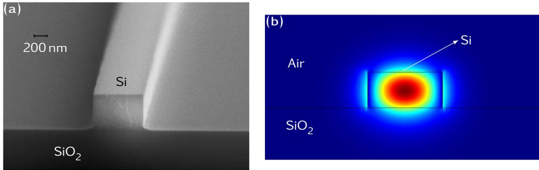
FIGURE 4.6 – (a) Image obtenue par Microscopie à Balayage Électronique (MEB) d’un guide d’onde ruban en SOI ( $e = 340$  nm,  $w = 500$  nm). (b) Exemple d’une simulation COMSOL du premier mode TE se propageant dans un guide d’onde à section rectangulaire  $340 \times 500$  nm<sup>2</sup>. Le calcul FEM est réalisé en deux dimensions dans le plan de coupe perpendiculaire à la direction de propagation du mode optique. La distribution du champ électrique  $E_x$  est représentée.
