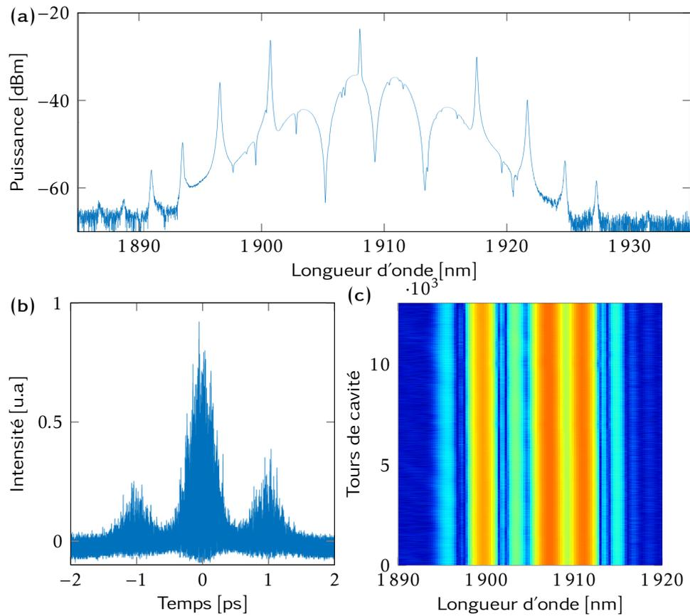
FIGURE 3.12 – **Observation expérimentale d’une molécule de deux solitons stable :** (a) le spectre moyen enregistré par l’OSA ; (b) trace d’auto-corrélation en mode interférométrique obtenue avec l’auto-corrélateur PulseCheck APE et (c) enregistrement DFT de la molécule stable sur plus de 13000 tours de cavité.
