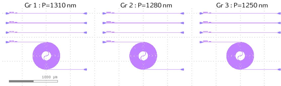
FIGURE 4.18 – Les différents groupes de guides d’onde de l’échantillon COSI 17-16 caractérisés. La différence entre les groupes est la période  $P$  des réseaux coupleurs, à savoir, de gauche à droite, 1310, 1280 et 1250 nm. Le facteur de remplissage  $f = 0,36$  reste le même pour les trois groupes.
