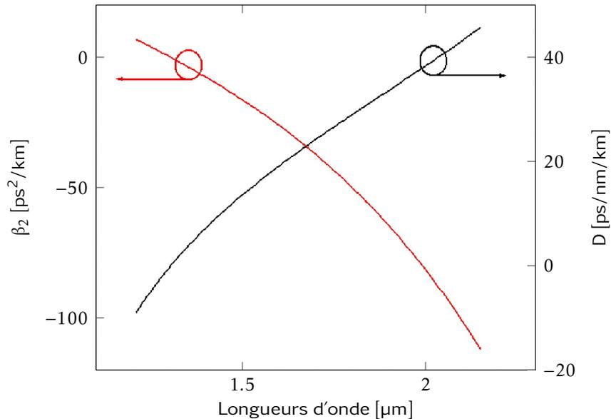
FIGURE 1.6 – Résultats du calcul numérique du coefficient de dispersion d'ordre 2 et du paramètre de dispersion pour une fibre monomode standard SMF28, on remarque que le zéro de dispersion chromatique se situe autour de 1,3  $\mu\text{m}$ , adaptée de [33].
