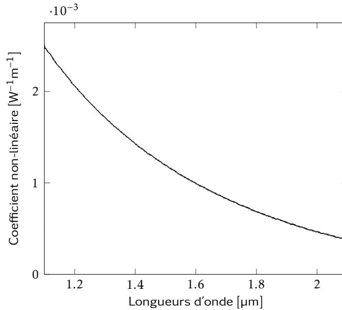
FIGURE 2.1 – Évolution du coefficient non-linéaire ( $\gamma$ ) pour une fibre monomode standard SMF28 en fonction de la longueur d'onde, on remarque que sa valeur est environ 3 fois plus faible autour de  $2\ \mu\text{m}$  par rapport à  $1,55\ \mu\text{m}$ . Adaptée de [33].
