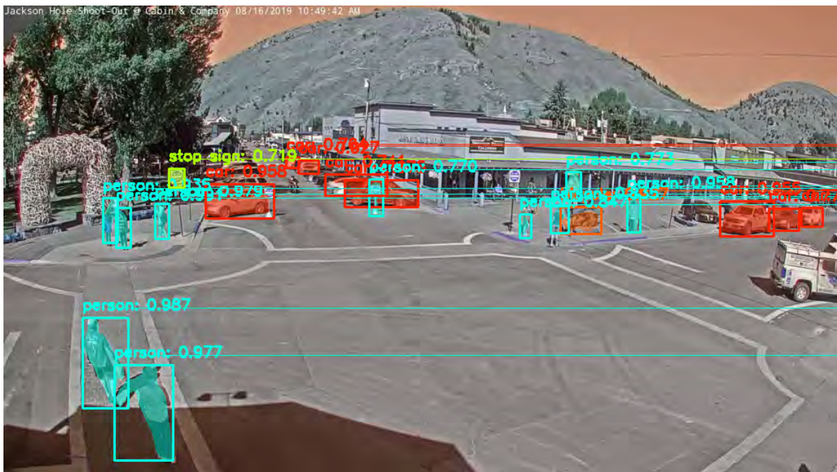
Figure 3.8: Détection de classes d'objets avec le modèle Mask RCNN
