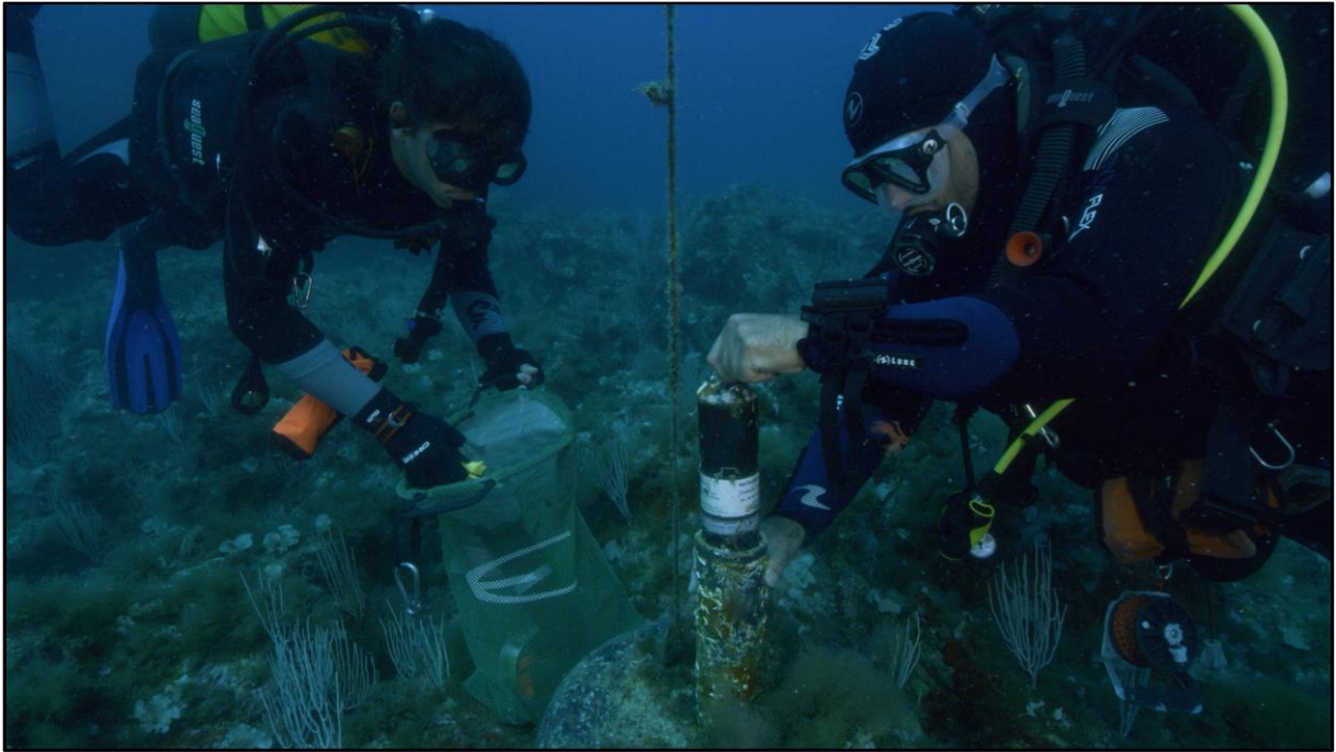
Figure 22 : Changement de VR2 pour la récolte des données et le changement de batterie (René Heuzey).
