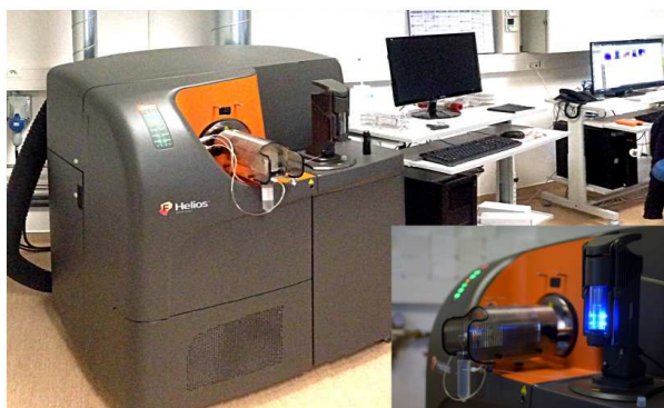
FIGURE 2 – Photo du CyTOF (Helios) utilisé par la plateforme de cytométrie de Gustave Roussy.
