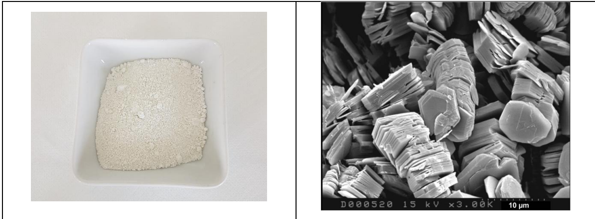
Figure 43 : a) Poudre de kaolin, b) Structure de la kaolinite observée par MEB [67].
