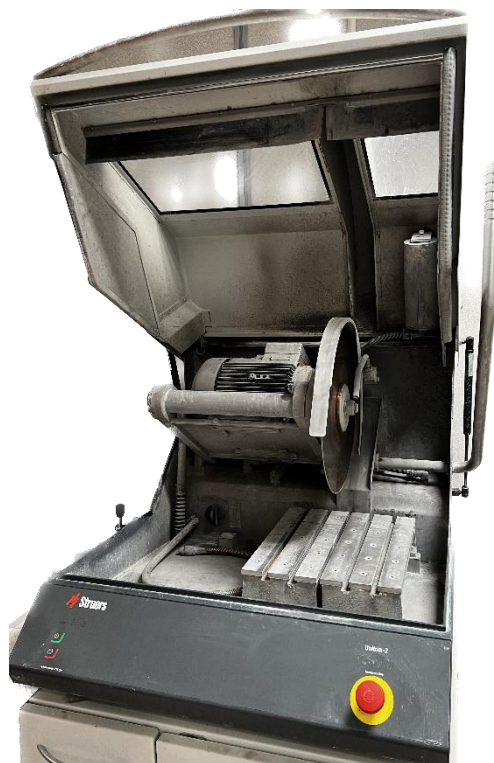
Figure 60 : Scie circulaire utilisée pour découper l'échantillon de mortier.
