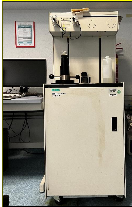
Figure 39 : Porosimétrie par intrusion de mercure AutoPore IV 9500 de Micromeritics.
