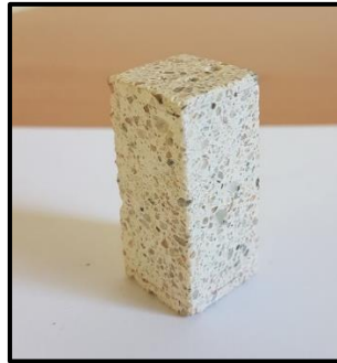
Figure 58 : Photographie d'un échantillon modèle utilisé pour les essais d'imbibition macroscopique.
