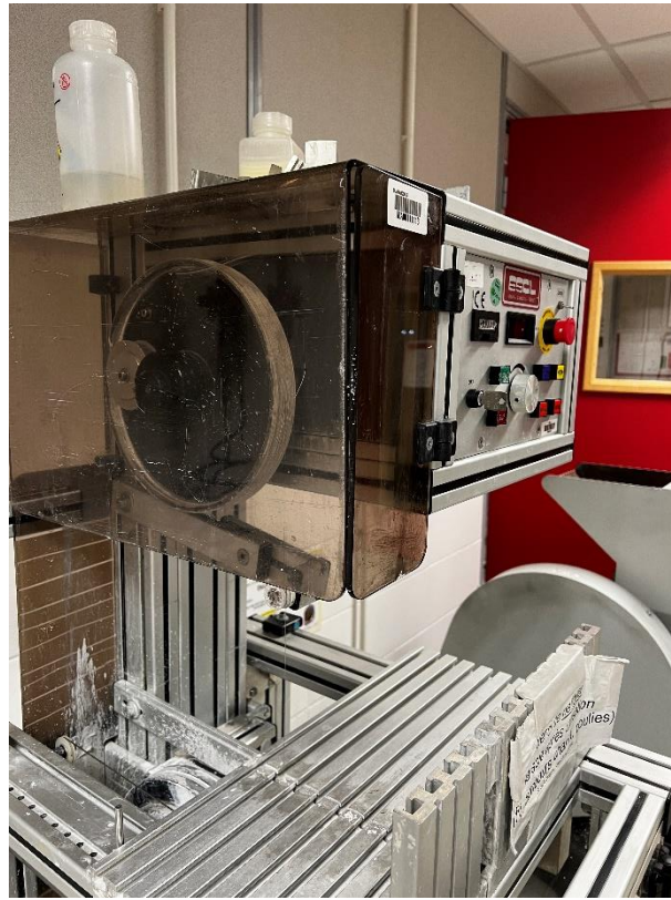
Figure 59 : Scie à fil utilisée pour découper l'échantillon de mortier.
