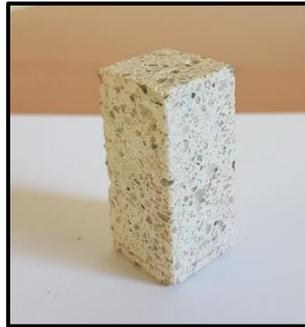
Figure 58 : Photographie d'un échantillon modèle utilisé pour les essais d'imbibition macroscopique.
