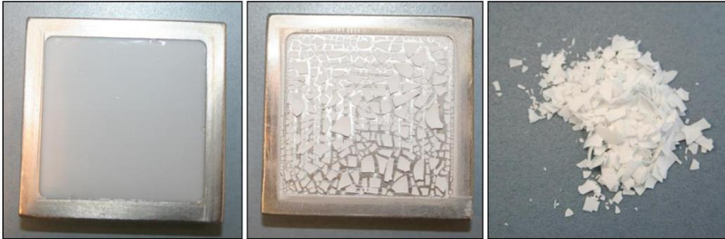
Figure 5 : Séchage d'une couche de gel aspirable et observation des paillettes millimétriques [1].
