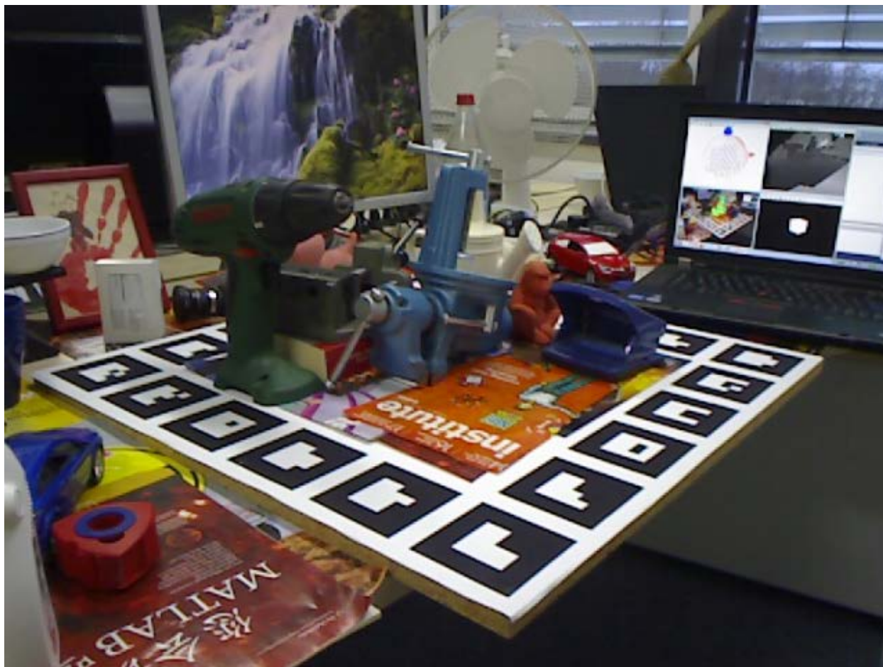
FIGURE 5.3 – Image de LINEMOD où l’on aperçoit l’ordinateur qui gère l’acquisition des images. On y voit l’outil d’acquisition implémenté par les auteurs. Probablement en Matlab. Cet outil permet de visualiser la position de la caméra par rapport au plateau ainsi que les points de vue déjà acquis.
