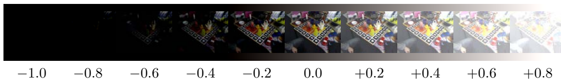
FIGURE 8.2 – Illustration de l'ajustement de la luminosité sur une image. Avec un \delta_L = -1.0 l'image est complètement noire, et avec \delta_L = +1.0 elle est complètement blanche.
