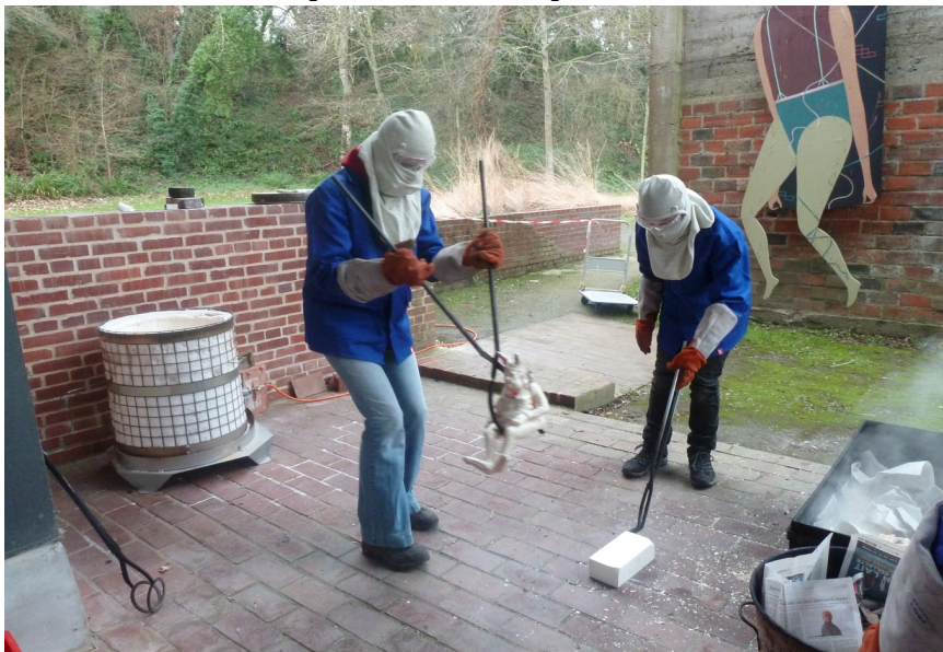
Cuisson inspirée de la technique traditionnelle du raku , réalisée lors de la résidence au musée de la Briqueterie (Langueux, Côtes d'Armor) en décembre 2018. Portée à 950°C, la pièce est sortie du four (à gauche de l'image) pour être exposée un court instant à l'air libre. Ce choc thermique provoque la glaçure de failles. Photographie personnelle.
