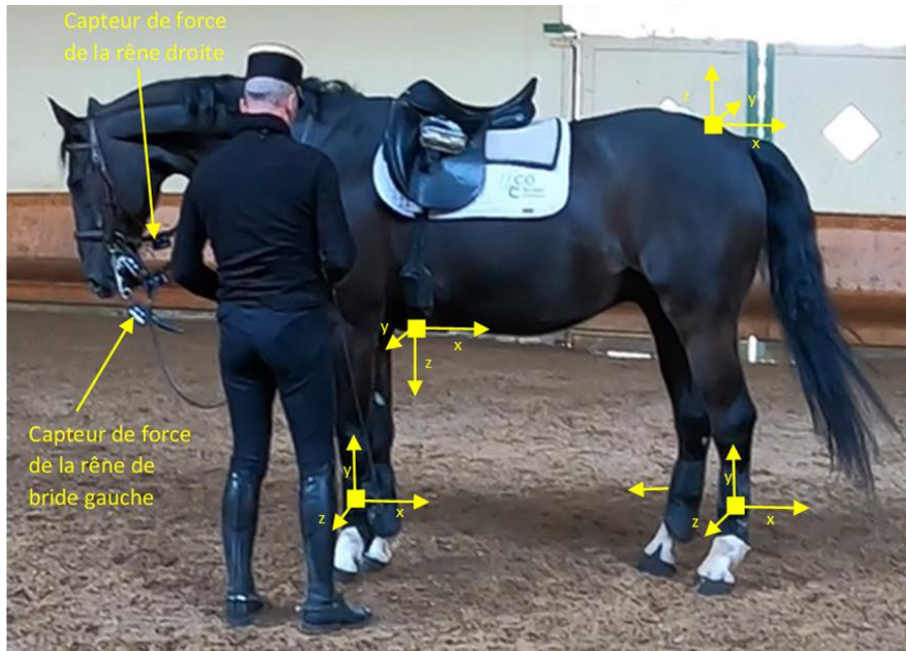
Figure 4: Equipement du cheval : 6 centrales inertielles de marque Shimmer (une à chaque membre, une au niveau du sternum et une au niveau de la croupe). Les 4 rênes sont équipées de capteurs de force (jauge de contrainte) 52
