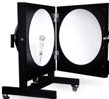
Figure 159 : Sphère d'intégration utilisée pour l'obtention des paramètres photométriques des films composites.
