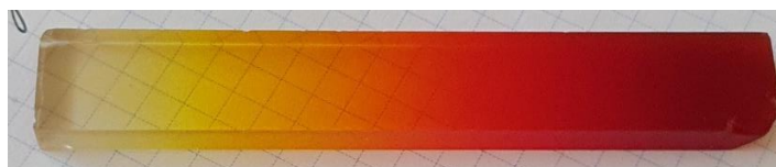
Figure 1 : Photographie de nanocristaux à base de chalcogénures de cadmium synthétisés dans une matrice vitreuse à base de silicate.
