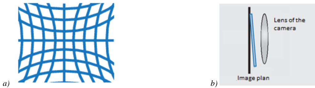
Figure 7.1. Schémas représentant (a) la distorsion radiale due à (b) la lentille de la caméra
