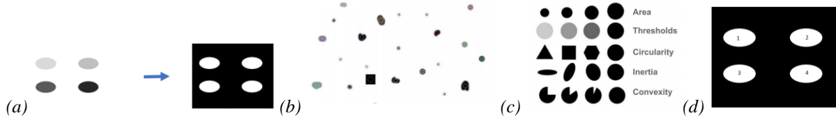
Figure 7.3. Schéma d'application de l'algorithme « SimpleBlocDetector » avec (a) Binarisation de l'image ; (b) Exemples de blobs ; (c) Illustration des critères de sélection des blobs et (d) Identification des blobs [9]
