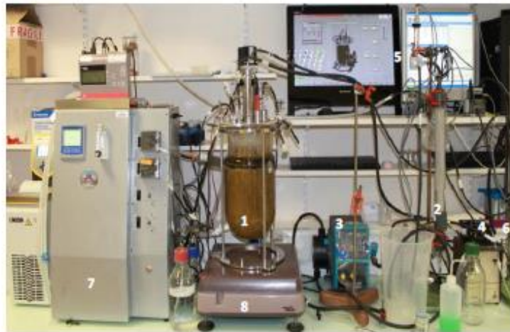
Figure 2.1. Photographie du montage d'un bioréacteur anaérobie pour la fermentation sombre [2]
