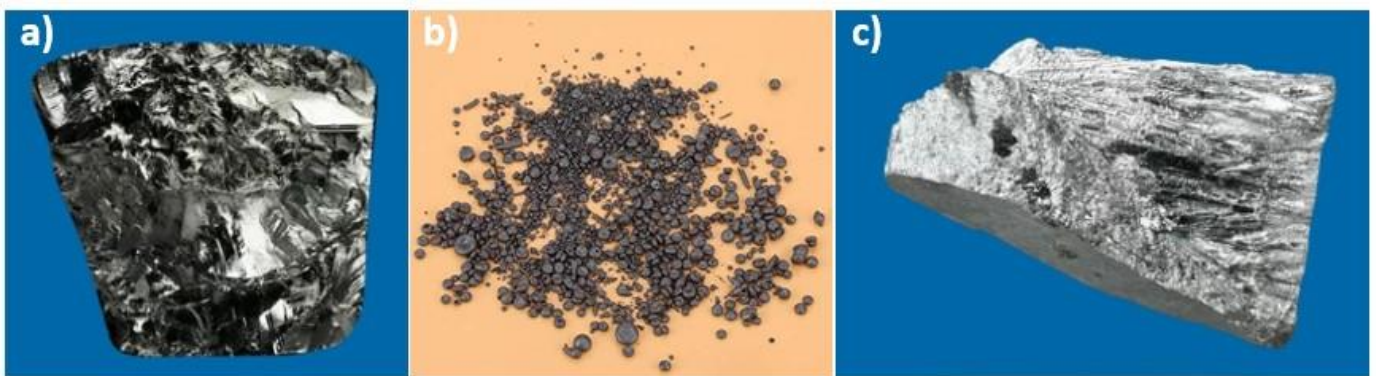
Figure III 2-6 : Précurseurs de départ composant les verres de cœur et de gaine : germanium (a), sélénium (b) et tellure (c).
