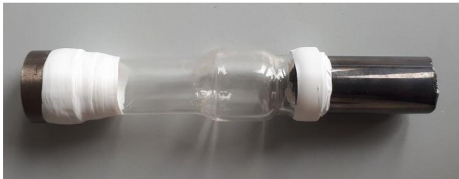
Figure II 3-1 : Photographie d'un holder en silice dans lequel est insérée une préforme de chalcogénure avant son étirage.
