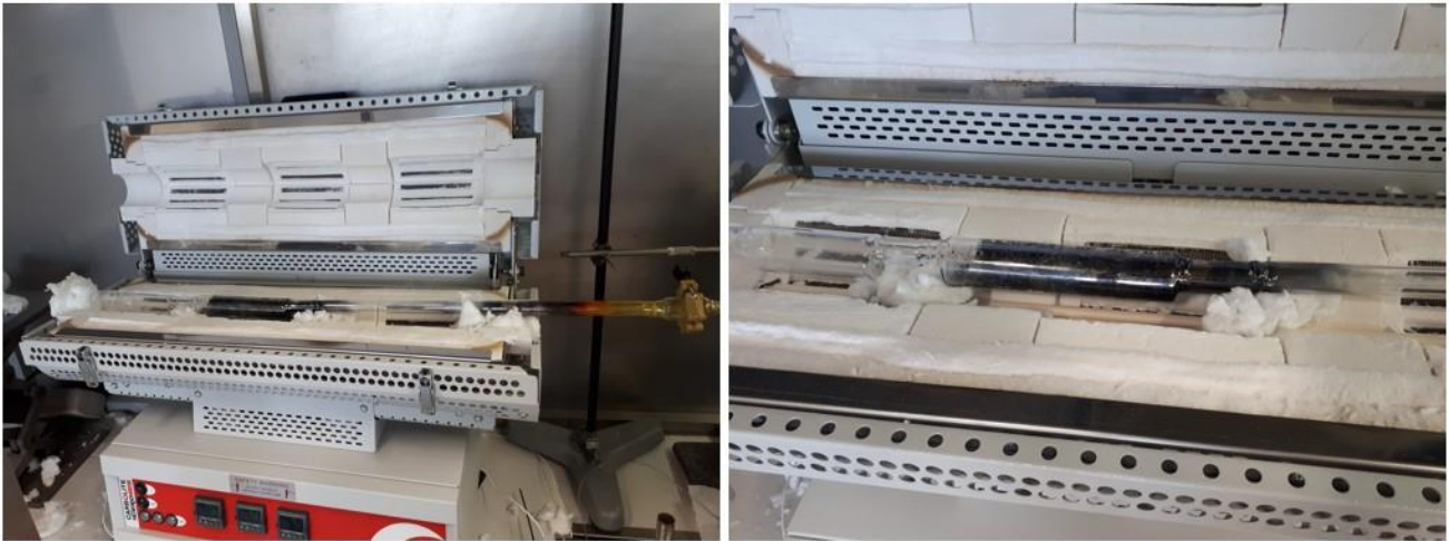
Figure III 2-11 : Fin de la distillation dynamique du verre. Le verre s'est condensé dans le deuxième réservoir en silice.
