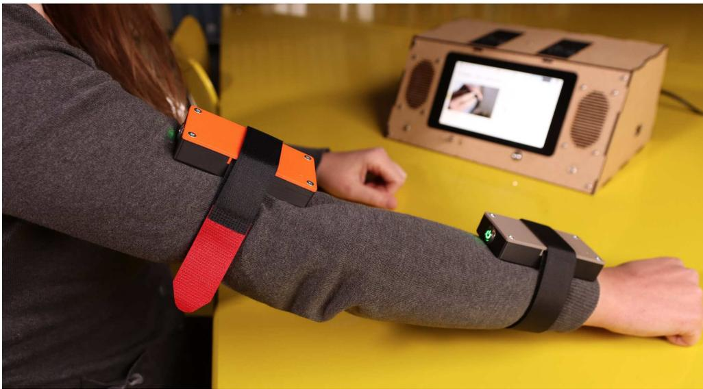
Figure 4.10 Système de port des capteurs
