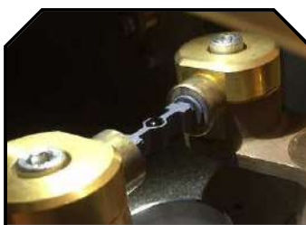
Photo 1 : Creuset de graphite placé entre les contacts du générateur Technegas™ PLUS.
