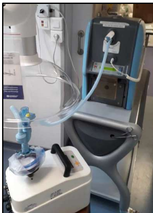
Photo 2 : Prélèvement sur filtre des nanoparticules de carbone aérosolisées à l'aide du préleveur d'aérosol PA 2000.
