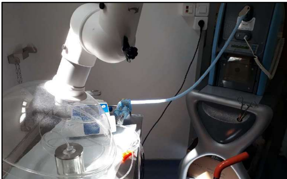
Photo 4 : Montage pour le prélèvement des nanoparticules de carbone par infusion dans le méthanol.
