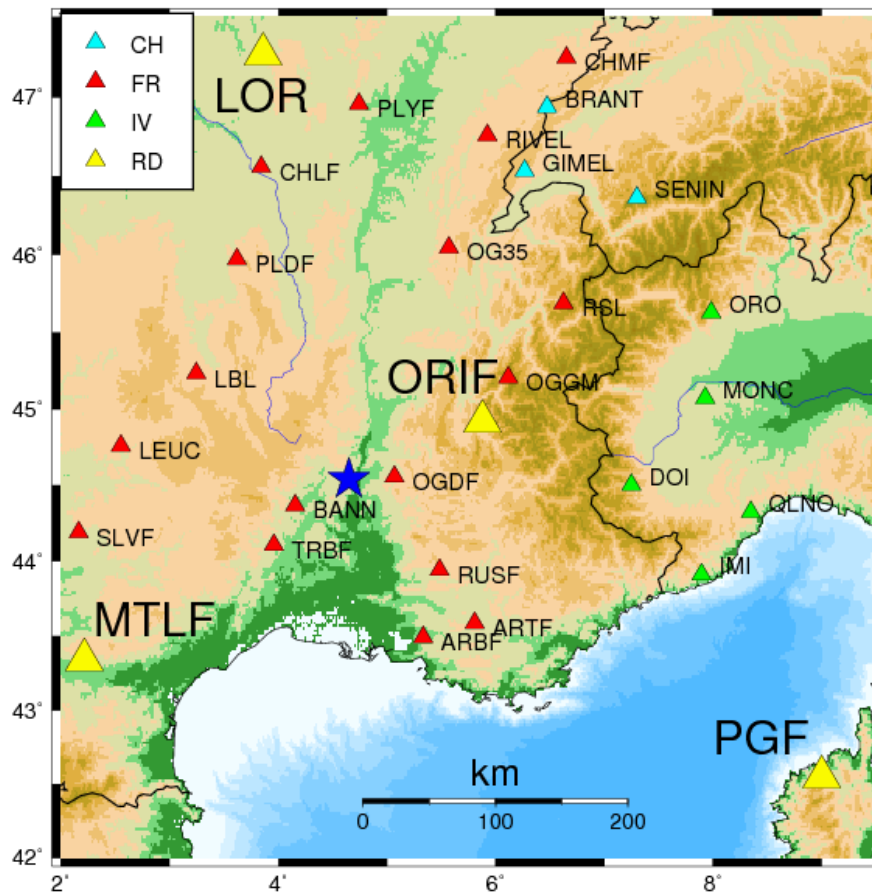
FIG. 3.6 – Zoom sur des stations sismologiques (triangles) présentes dans le sud-est de la France, et dans les zones limitrophes, et considérées pour les inversions GRiD MT. La couleur indique le réseau correspondant : bleu pour le réseau suisse (CH), rouge pour le réseau français (FR), vert pour le réseau italien (IV), jaune pour le réseau CEA (RD).
