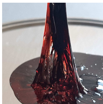
Photo IV.1. Test de probe-tack avec un hydrogel à 80% p/v de gélatine + 10 mM catéchol + 30 mM NaIO 4 montrant la présence des fibrines.
