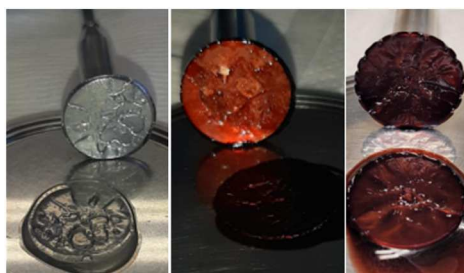
Photo III.2. Rupture des hydrogels à 3h à 25°C. Avec de gauche à droite G_{10}N_{10} (gélatine (250 Bloom) 10% p/v + 10 mM NaIO 4 ), G_{10}C_{20}N_{10} (gélatine (250 Bloom) 10% p/v + 20 mM catéchol + 10 mM NaIO 4 ), et G_{10}C_{60}N_{10} (gélatine (250 Bloom) 10% p/v + 60 mM catéchol + 10 mM NaIO 4 ).
