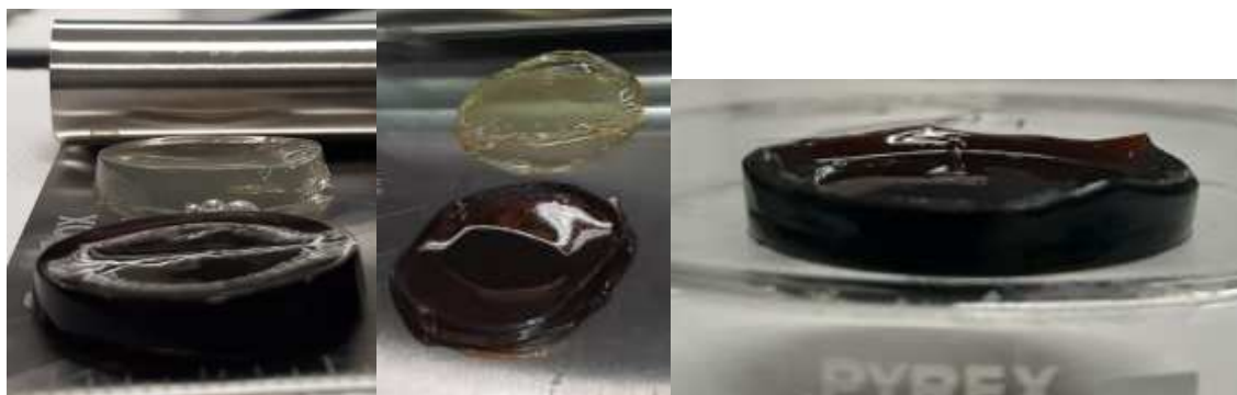
Photos III.1.(Gauche). Exemples d'hydrogels après le premier trempage à 24h dans le tampon acétate. (Milieu). Exemples d'hydrogels quelconques après séchage de 24h à température ambiante. (Droite). Exemple d'hydrogel après le second trempage de 24h post -séchage.
