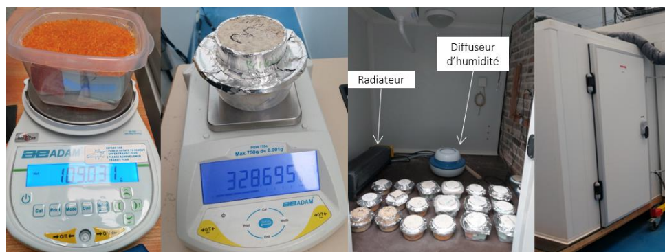
Figure III-8 : Dispositif expérimental de mesure de la perméabilité à la vapeur d'eau.
