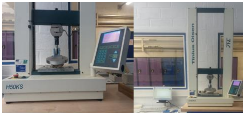
Figure II-7 : Presse électromécanique H50KS de TINIUS OLSEN.
