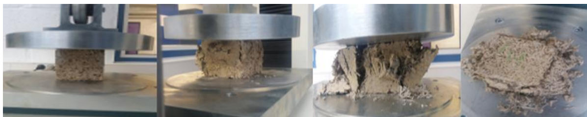
Figure II-11 : Evolution de la déformation du BC+0%MCP durant la compression.
