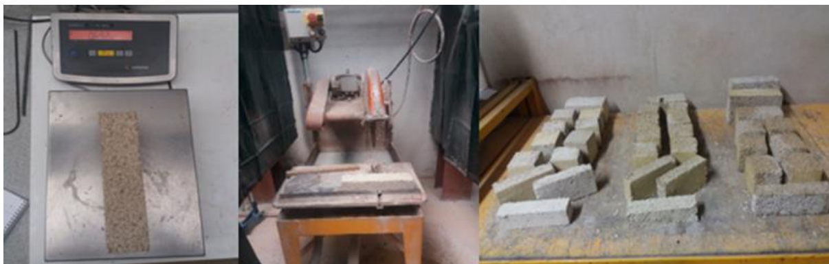
Figure II-6 : Conditionnement des échantillons pour la caractérisation mécanique.
