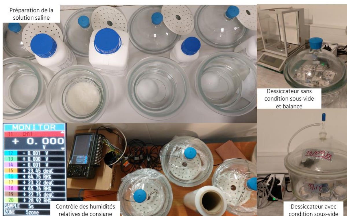
Figure III-2 : Dispositif expérimental de mesure de sorption et système de contrôle des humidités de consigne.
