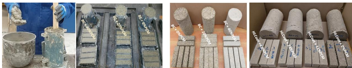
Figure II-3 : Moulage, tassage et exposition des échantillons étudiés.
