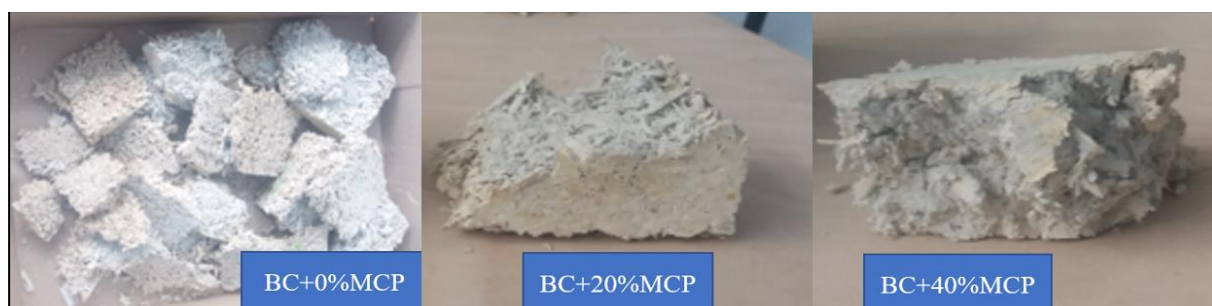
Figure II-23 : Résidus des matériaux après la compression
