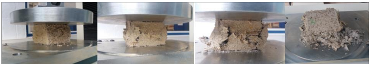
Figure II-15 : Evolution des fissurations dans un BC+20%MCP en compression.
