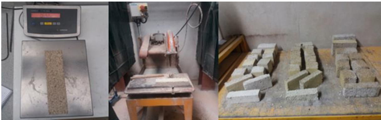
Figure II-6 : Conditionnement des échantillons pour la caractérisation mécanique.
