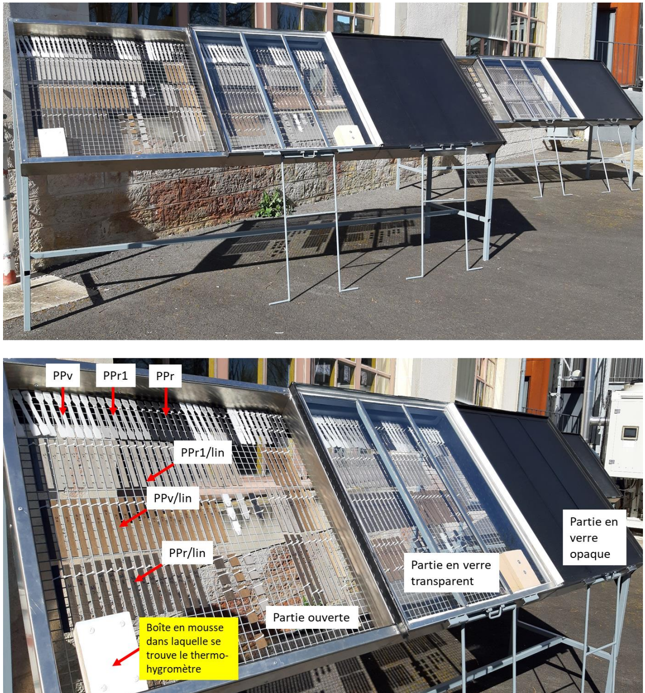
Figure II. 7 Supports d'exposition des matériaux soumis au vieillissement naturel à Nevers
