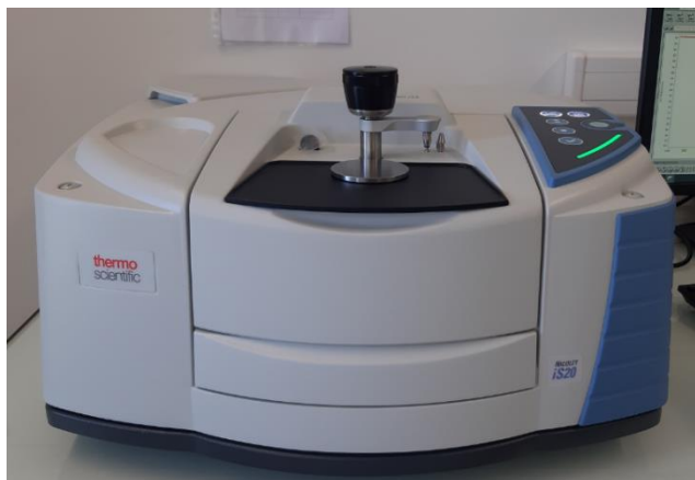
Figure II. 11 Spectromètre FTIR Nicolet™ iS20
