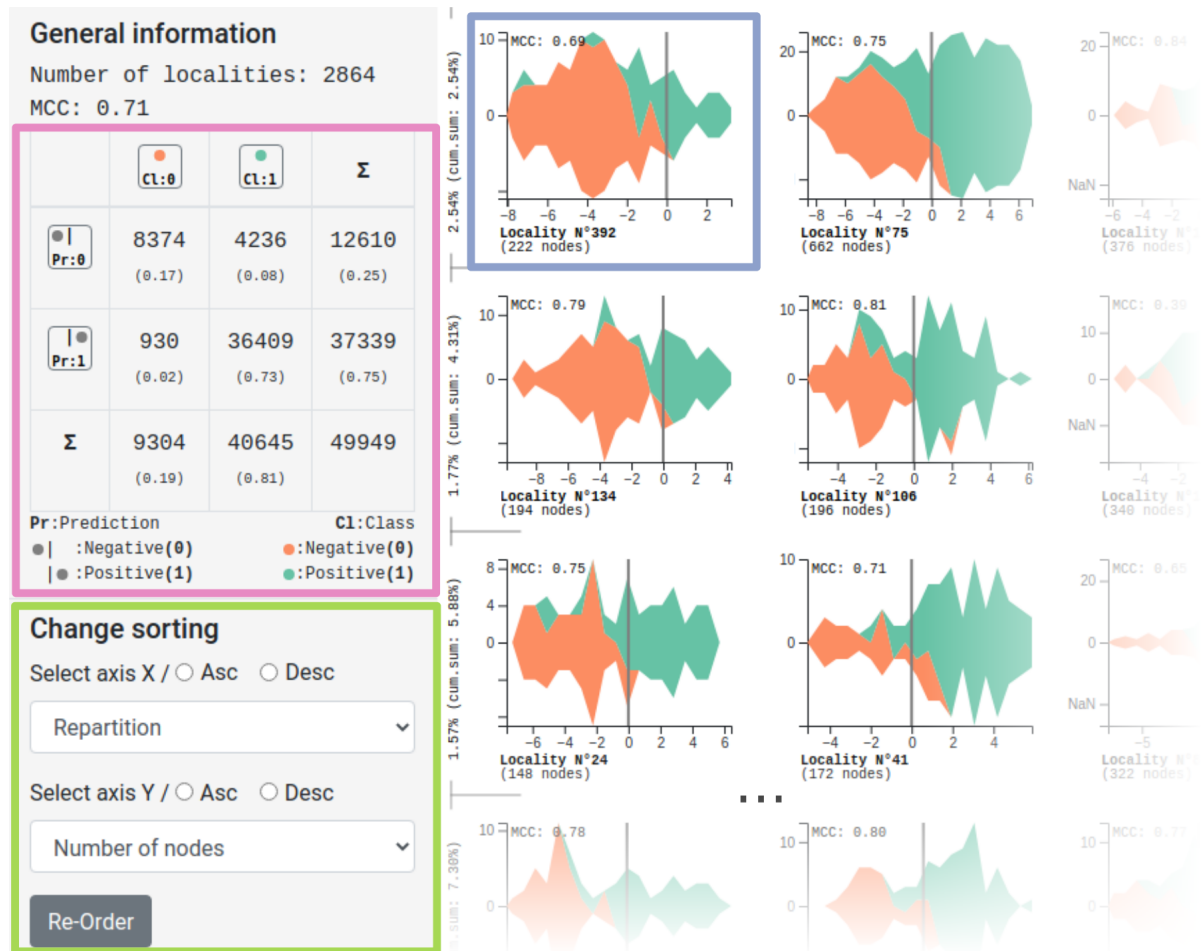
FIGURE 3.6 – Vue globale de l'espace de représentation du texte. Dans le volet de droite, dans l' encadré bleu , un diagramme de flux représente la distribution des données autour de la frontière de décision pour une localité. La position de la ligne grise dans chaque diagramme de flux indique la position de la frontière de décision. Les diagrammes de flux sont organisés dans une matrice et ordonnés en fonction de plusieurs mesures (taille de la localité, nombre de mauvaises classifications, etc.). Dans le volet de gauche, dans l' encadré rose , on retrouve la matrice de confusion pour les prédictions, et dans l' encadré vert , les différents types d'ordonnancement disponibles.
