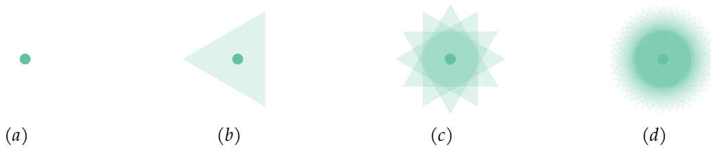
FIGURE 3.3 – Création des ensembles simpliciels. (a) Un point dans un espace à deux dimensions. (b) Un 2-simplexe ou triangle dans un espace à deux dimensions ayant pour barycentre un point. (c) Quatre 2-simplexes ou triangles ayant pour barycentre un même point formant un ensemble de cardinalité 4 de simplexes autour d'un point. (d) Un ensemble simpliciel de cardinalité 16 d'un point. Les opacités des simplexes des figures (b-c) et (d) sont différentes à des fins de facilitation de lecture.
