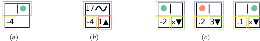
FIGURE 3.11 – Descripteurs des données placés dans la liste des textes. Les descripteurs sont placés hypothétiquement du plus éloigné de la frontière de décision à gauche en (a) au plus proche de la frontière de décision à droite en (c). Le second descripteur, en (b), est le descripteur de la donnée sélectionnée. Le descripteur à sa gauche, en (a), et les descripteurs à sa droite, en (c), concernent respectivement ses voisins plus éloignés ou plus proches de la frontière de décision. Les rectangles bleus montrent la classe de la donnée en la colorant. La position du point informe l'utilisateur sur la classification (à gauche pour une classe et à droite pour une autre). Les données oranges (points) sont correctement classifiées à gauche de la ligne centrale. Inversement, les données vertes (points) sont correctement classifiées à droite de la ligne centrale. On observe ici par exemple que la donnée la plus à droite en (c) n'est pas correctement classifiée. Le rectangle rose informe l'utilisateur sur le nombre de chemins entre la donnée sélectionnée et la frontière de décision. Les carrés jaunes indiquent le degré d'incertitude du réseau de neurones par rapport à une prédiction. Une valeur précédée d'un symbole moins signifie à \times 10^{-\text{valeur}} . Un point signifie la valeur elle-même (e.g., "-4" signifie une incertitude d'ordre 10^{-4} , ".4" signifie une incertitude proche de .4). Le carré rouge indique le nombre de voisins de la donnée sélectionnée plus éloignés de la frontière de décision que la donnée sélectionnée ( \times signifie aucun). Les carrés verts indiquent le nombre de voisins plus proches de la frontière de décision ( \times signifie aucun).
