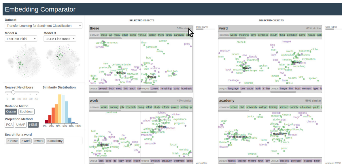
FIGURE 2.15 – Visualisation de quatre mots dans l'espace de représentation du plongement lexical de deux réseaux différents : FastText [Mik+17] et LSTM [HS97]. On observe ici les plus proches voisins des mots sélectionnés et donc les similarités et différences entre les voisins de ces mots dans les plongements lexicaux. On observe par exemple qu'un plus grand nombre de voisins est identique entre les deux plongements pour le mot "word" (61%) que pour le mot "work" (49%). À gauche, sont présents les paramètres utilisés pour cette visualisation, à savoir une projection à l'aide de la t-SNE , où les 50 plus proches voisins de chaque mot sont considérés à l'aide d'une similarité cosinus [BCS19].
