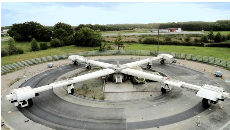
Figure II-14 : Manège de fatigue de l'UGE à Nantes
