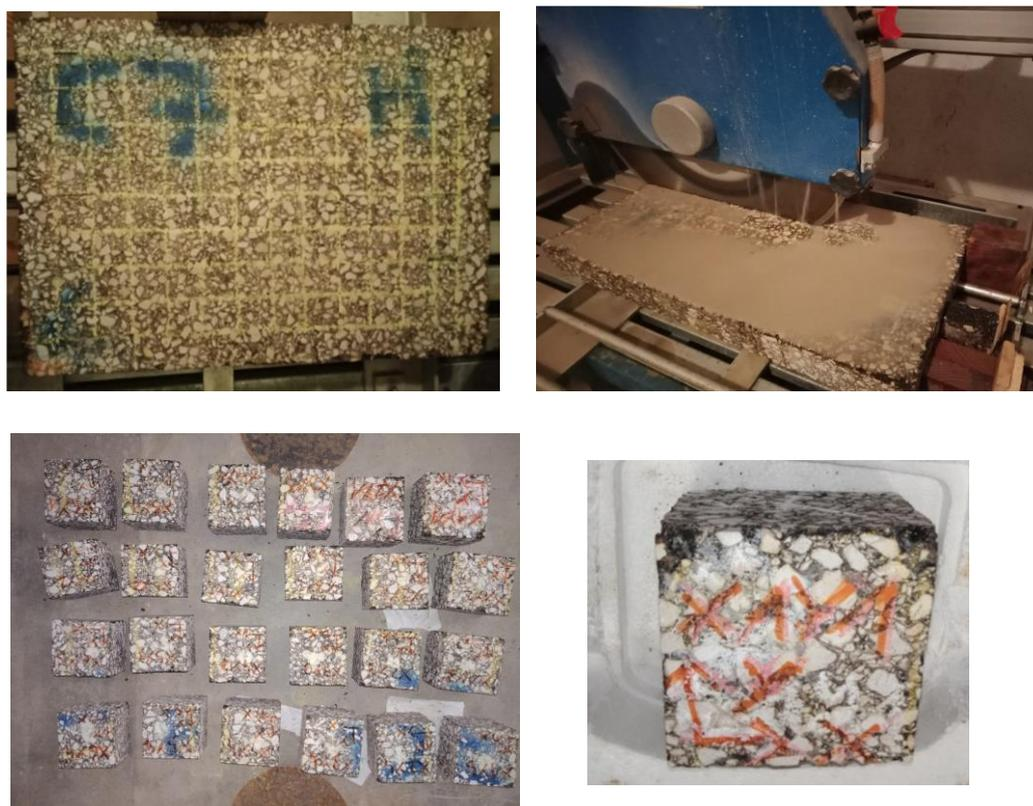
Figure II-45 : Découpe de la plaque prélevée sur DIJ C B pour des mesures sur des cubes
