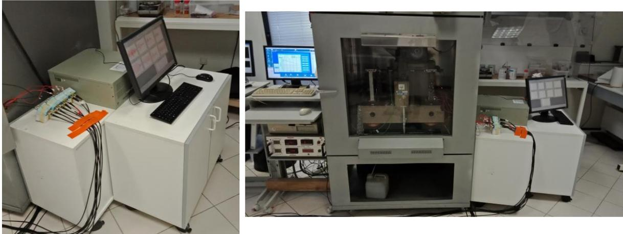
Figure II-25 : Système d'acquisition des signaux d'émission acoustique
