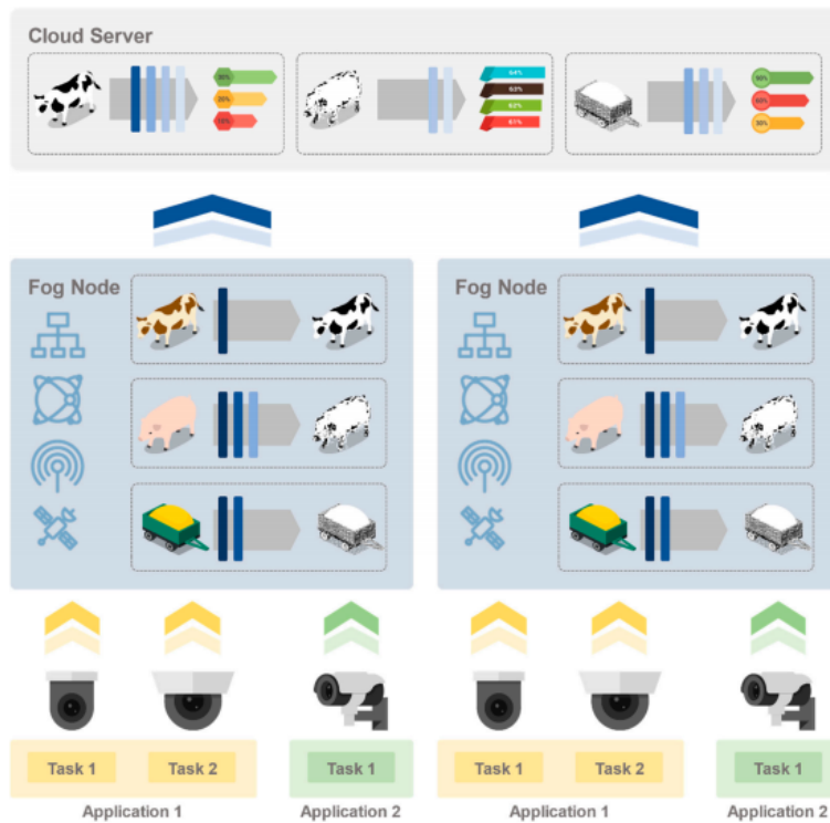
FIGURE 2.7 – Exemple de système intelligent d'agriculture basé sur le Fog computing [Lee et al., 2020]
